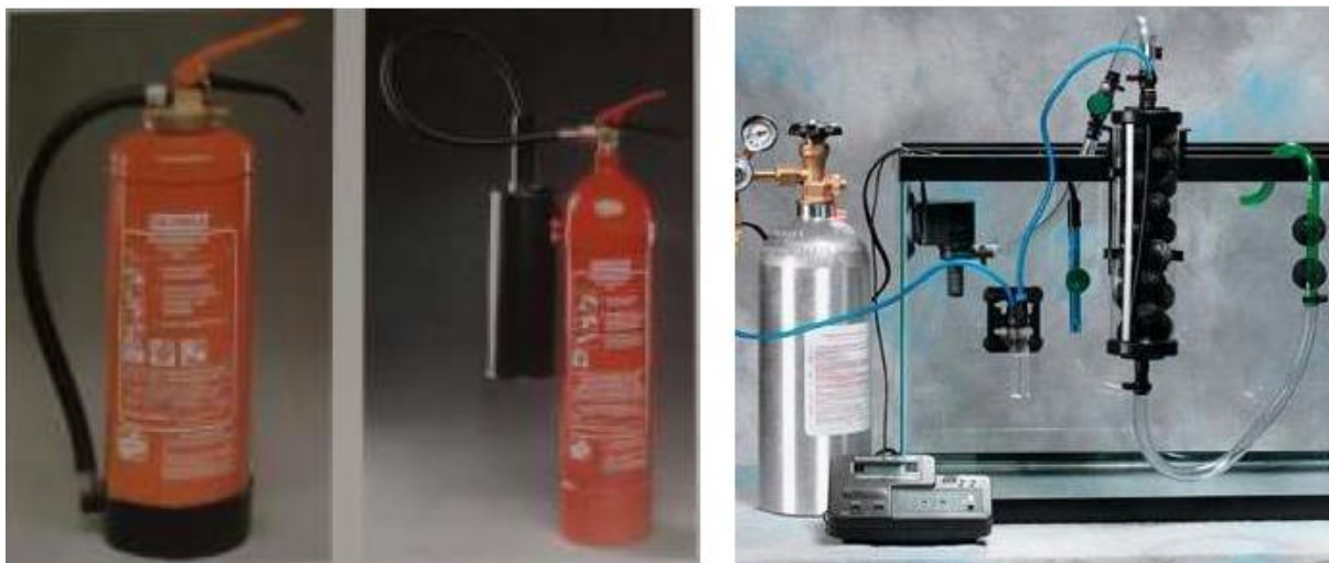
Slika 6. Ispitivanje prenosivih protupožarnih aparata i testiranje sustava CO 2 na brodovima (Prema: Ivošević, Špiro, Održavanje i bezbjednost broda , 2016.)
