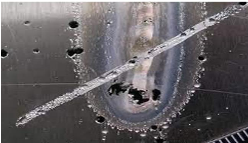
Slika 28. Rupičasta korozija u cijevi [5]
