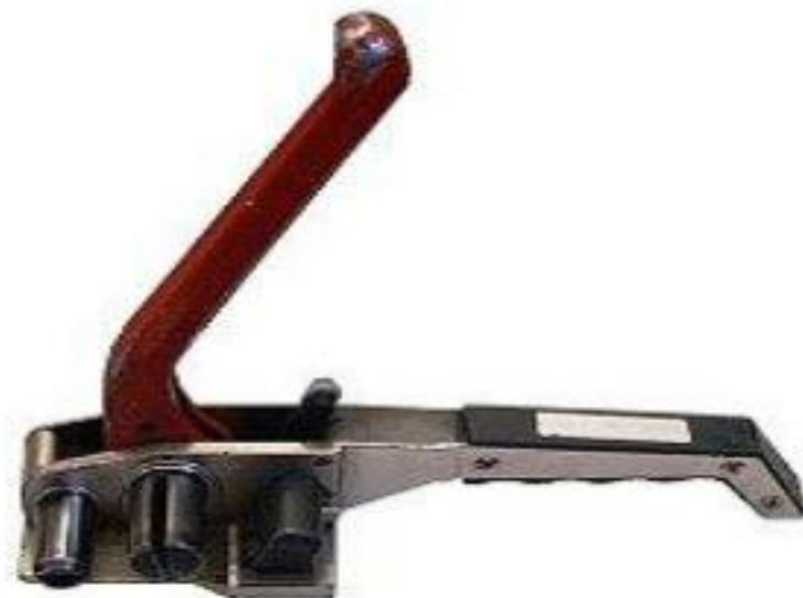
Slika 48. Jedan od tipova zatezača za sintetičke brage [8]
