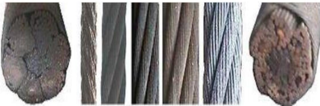
Slika 39. Različita struktura čelične užadi – poprečni presjek i uzdužni pogled [8]
