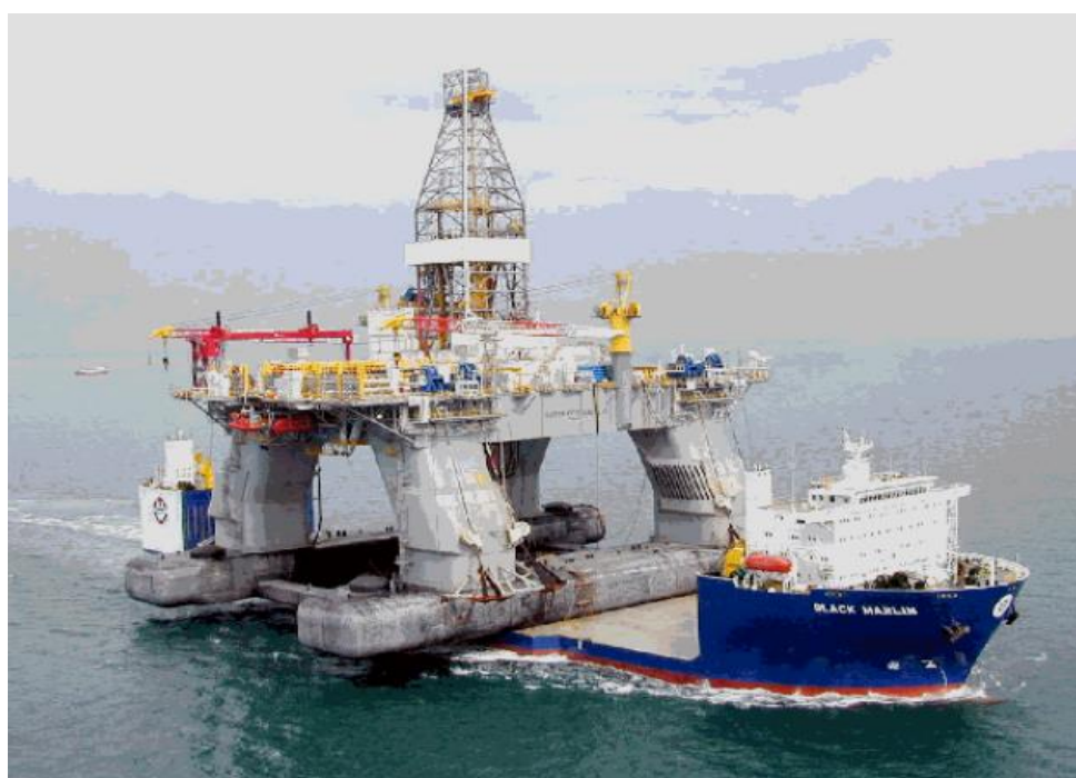
Slika 21. Brod Black Marlin pri transportu platforme iz Južne Koreje u Meksički zaljev [22]
