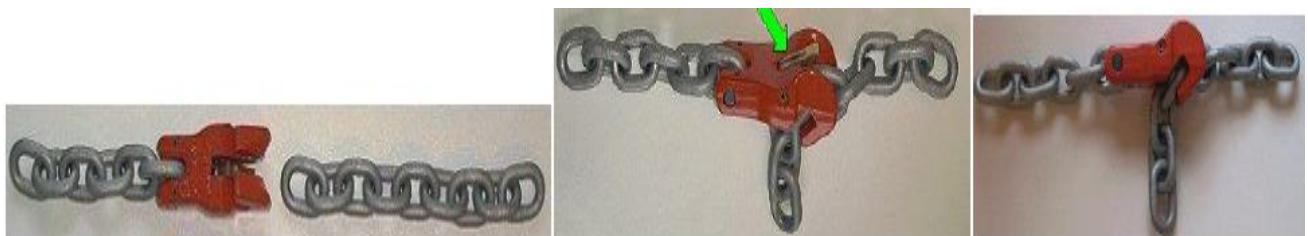
**Slika 46. Skraćenje lanca sa specijalnom kukom zvanom kandžom i osiguravajućom polugom [8]**
