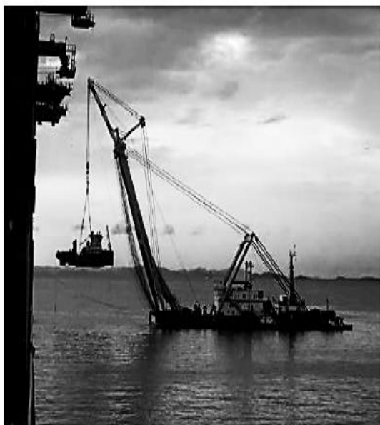
Slika 37. Plutajuća barža, uključena u operaciju podizanja teškog tereta [10]
