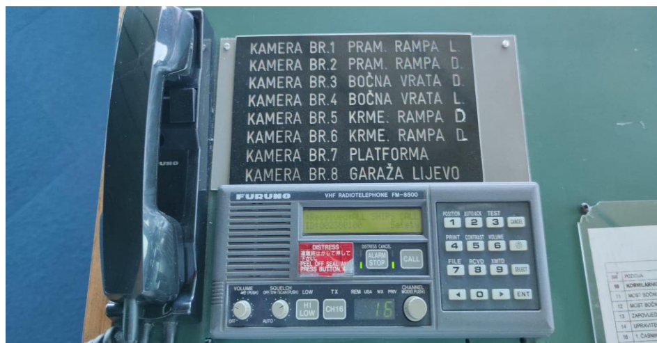
Slika 18. VHF Radiotelephone 8500 (FURUNO)
