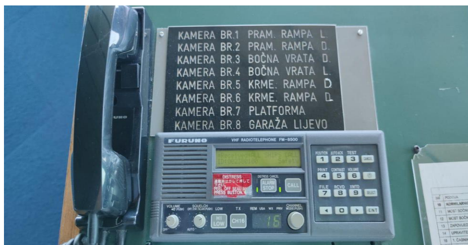
Slika 18. VHF Radiotelephone 8500 (FURUNO)
