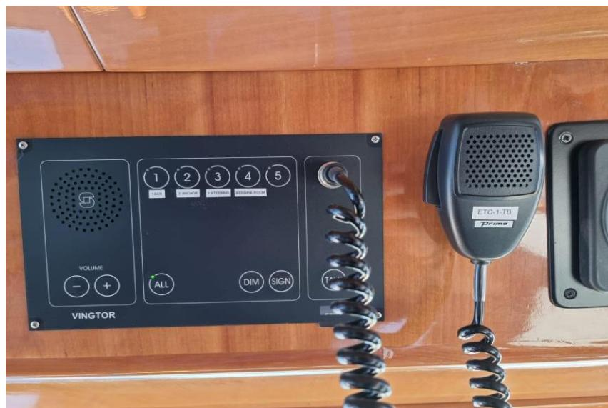
**Slika 27. Ručni mikrofon ETC 1TB**
