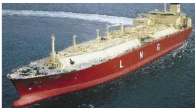
Slika 6. Membranski tip broda [1]
