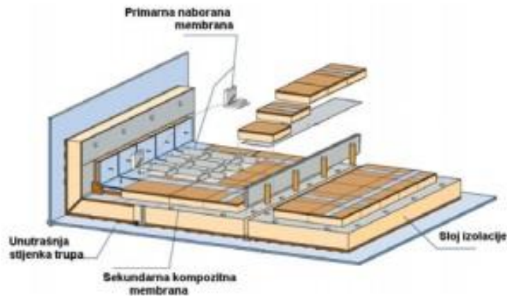
Slika 10. Presjek Technigaz Mark III spremnika [9]
