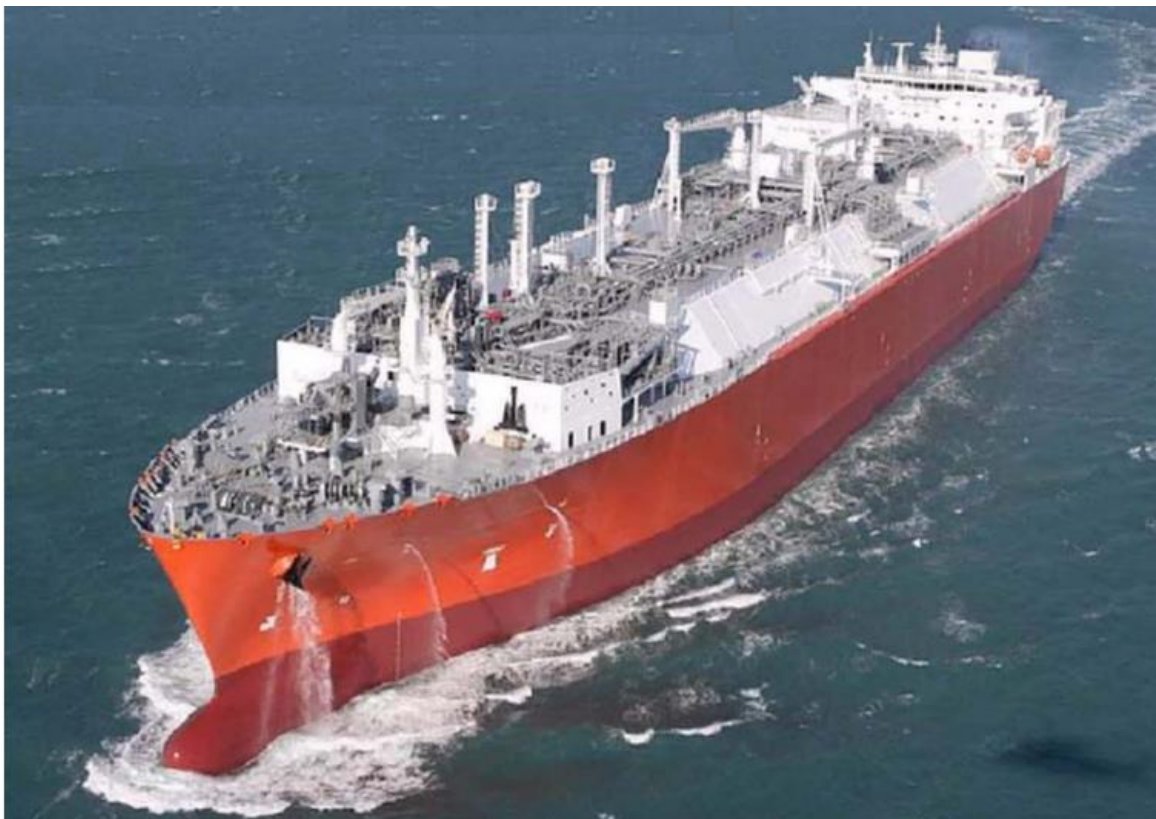
Slika 17. LNG tanker Grandis H2226 [4]
