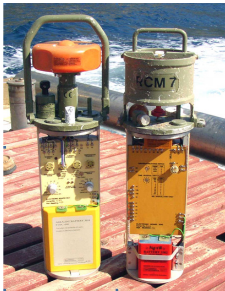
Slika4. Ekmanov mehanički (gore) i Aanderaa električni strujomjer (dolje) [3]
