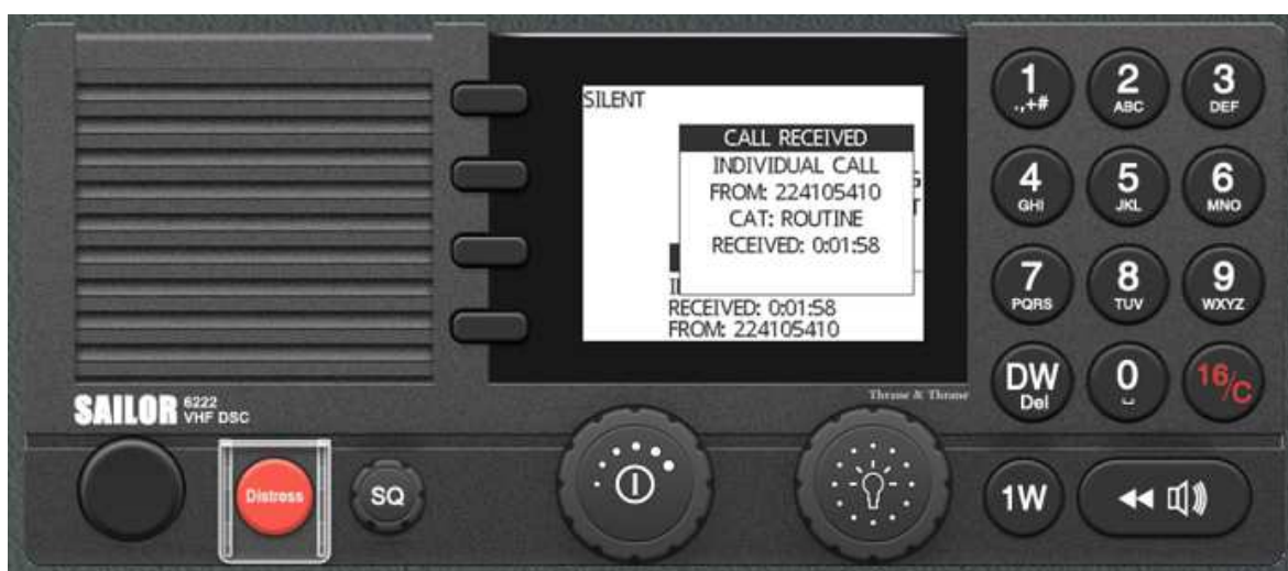
Slika 13. VHF DSC uređaj brodske radiostanice m/v Glasgow prilikom zaprimanja poziva
