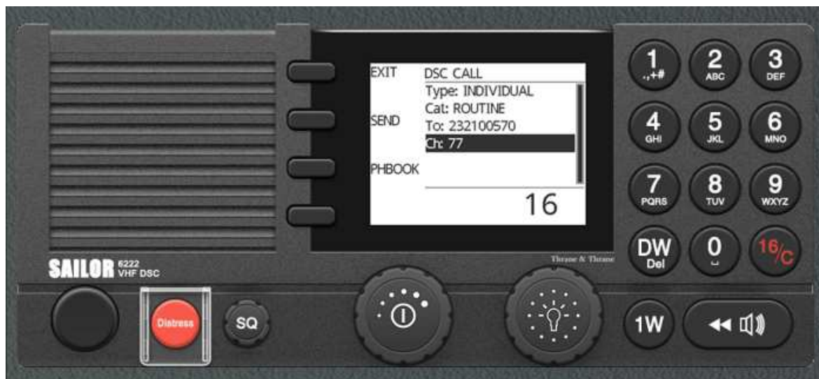
Slika 11. Pozivanje brodske radiostanice m/v Glasgow
