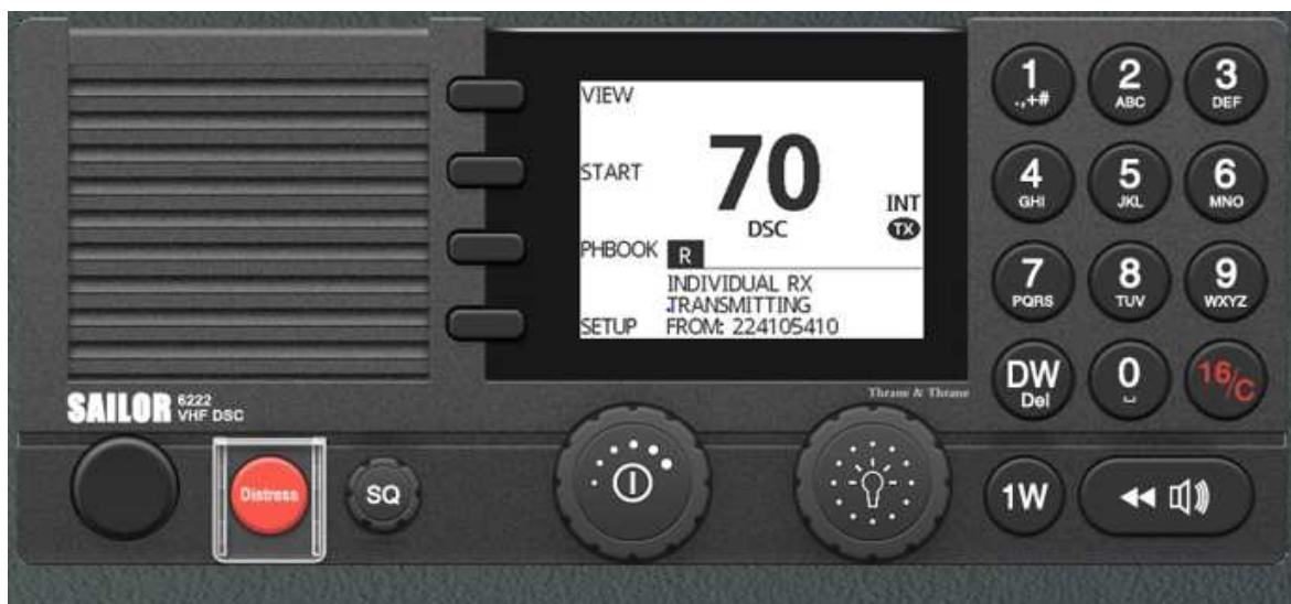
Slika 14. Potvrda uspostavljenog poziva na broskoj radiostanici m/v Glasgow
