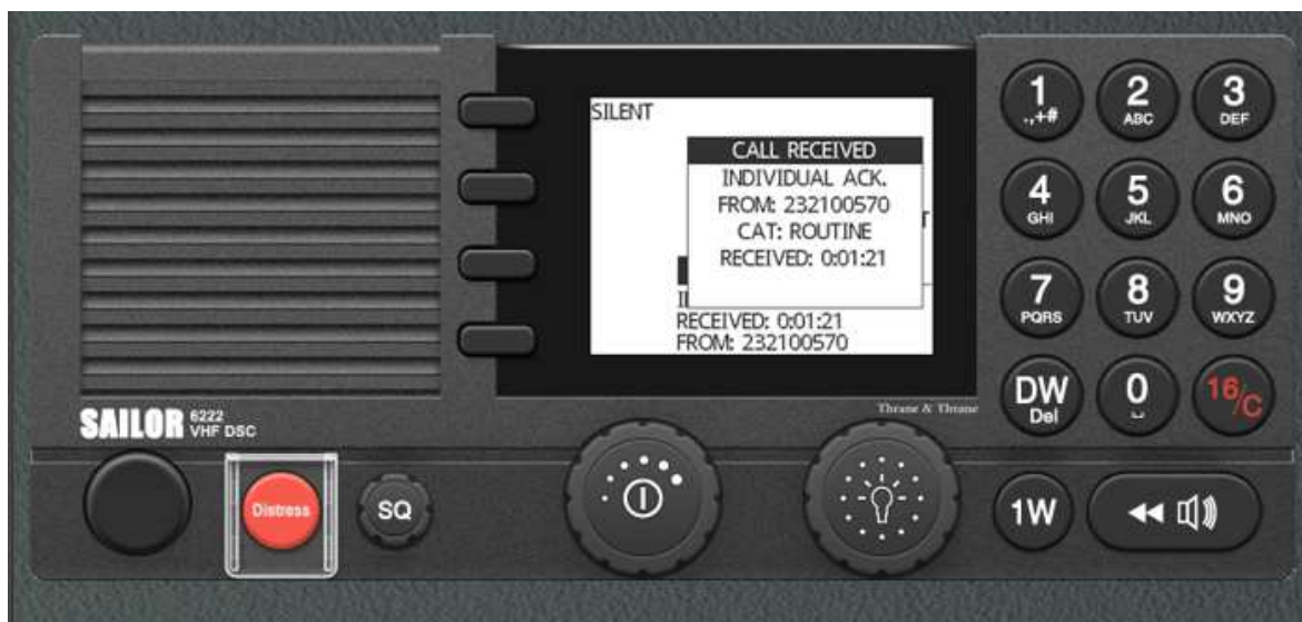
Slika 15. Primljena potvrda poziva na polaznoj radiostanici m/v Arcona
