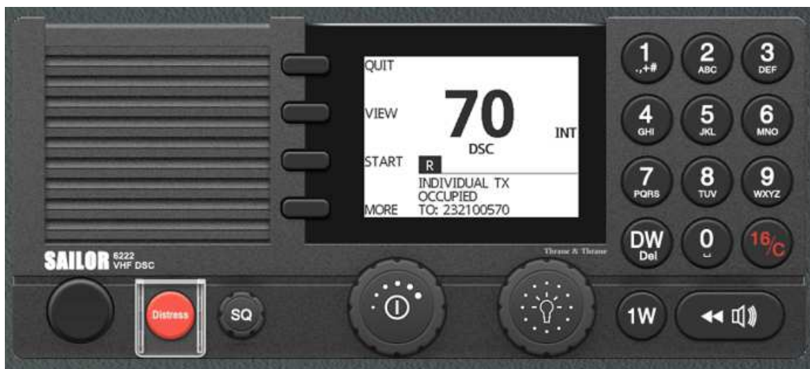
Slika 12. Poziv upućen brodskoj radiostanici m/v Glasgow
