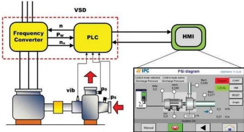
**Slika 9. Sustav upravljanja i dijagnostike centrifugalne pumpe [8]**
