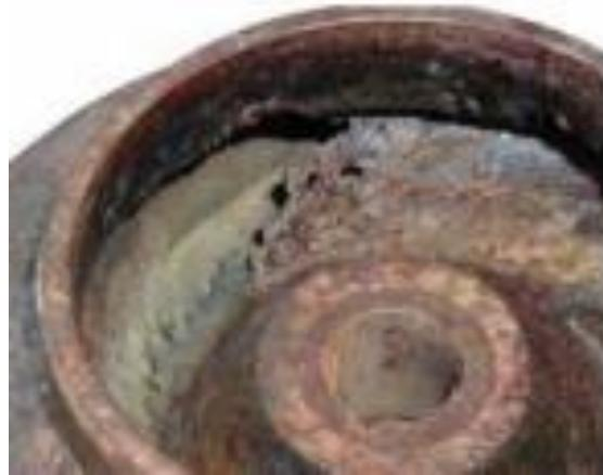
**Slika 9. Kavitacijska oštećenje rotora centrifugalnih pumpi [4]**
