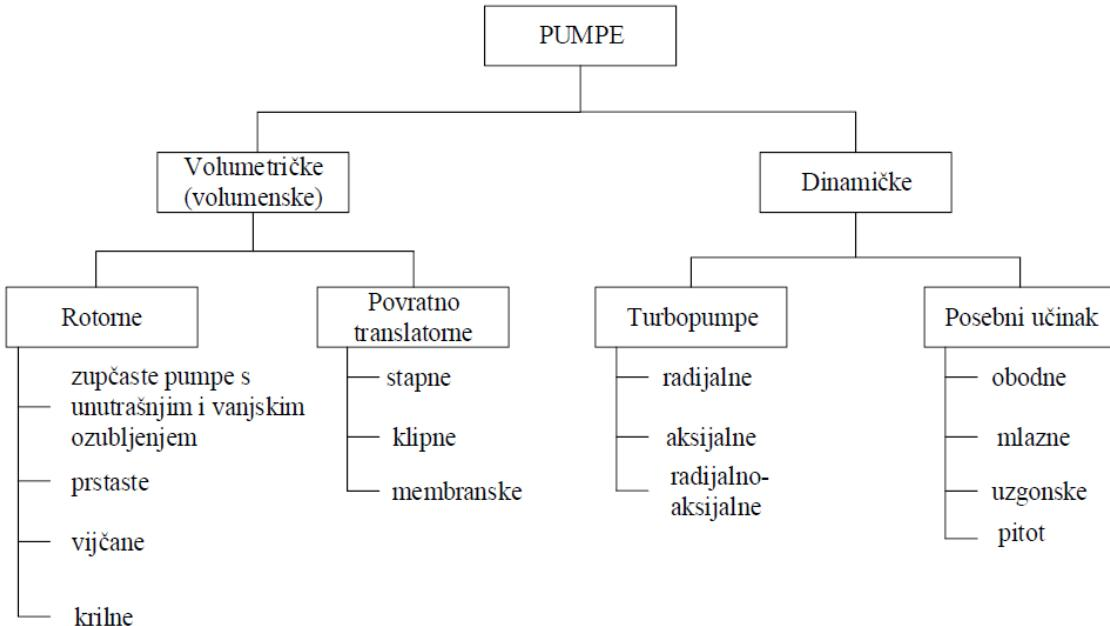
**Slika 1. Podjela pumpi prema mehanizmu izmjene energije [1]**
