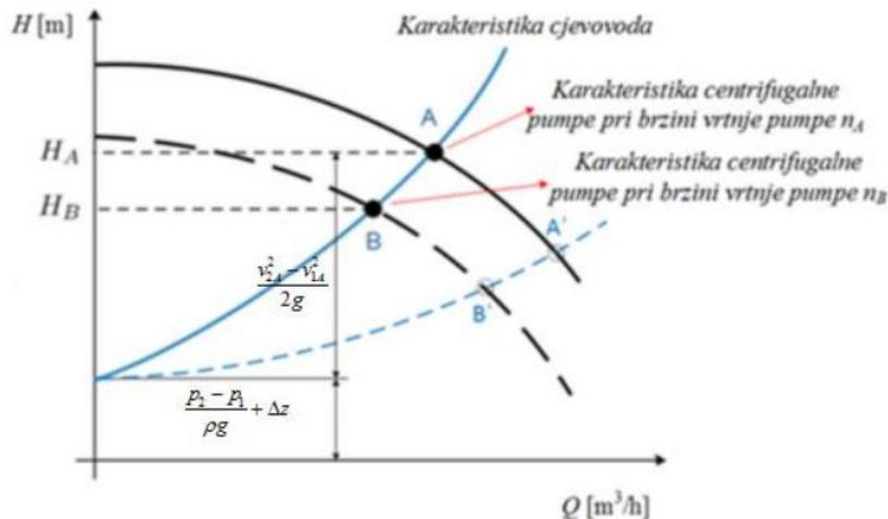
Slika 7. Q-H krivulja karakteristike centrifugalne pumpe [1]
