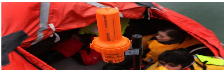
Slika 1. SART uređaj postavljen na najvišu poziciju na splavi [6]
