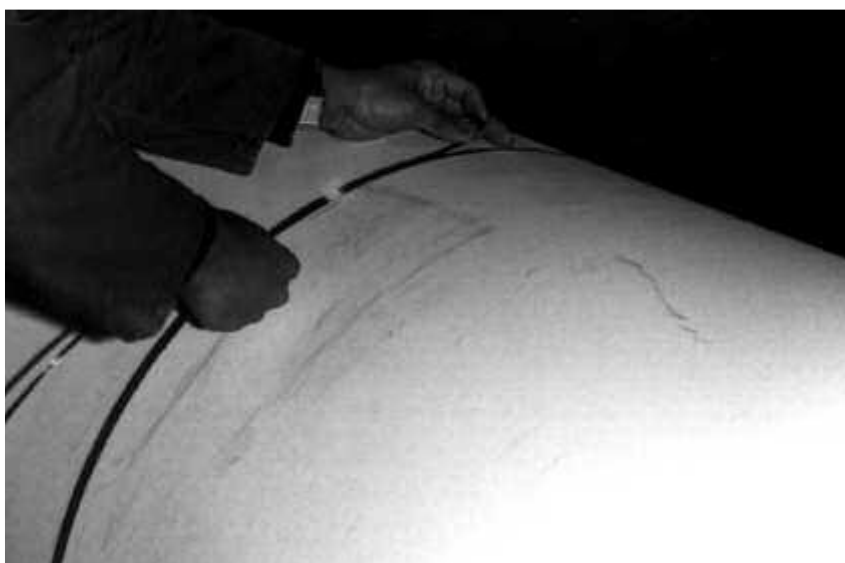
Slika 22. Mjerenje promjera ležaja pomoću Pi trake [10]
