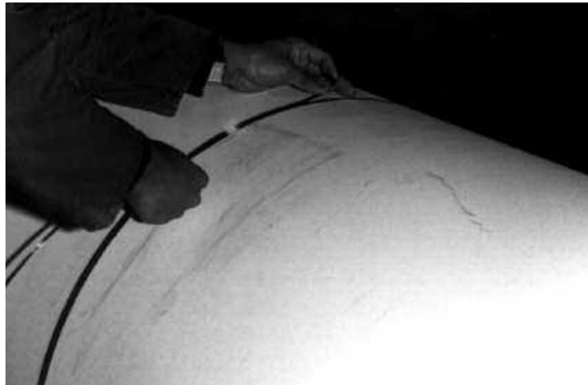
**Slika 22. Mjerjenje promjera ležaja pomoću Pi trake [10]**
