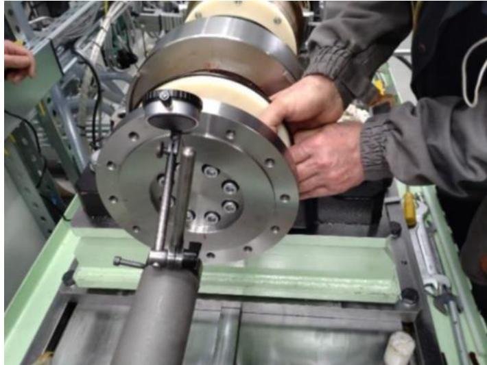
Slika 33. Centriranje vratila i kućišta ležaja [12]
