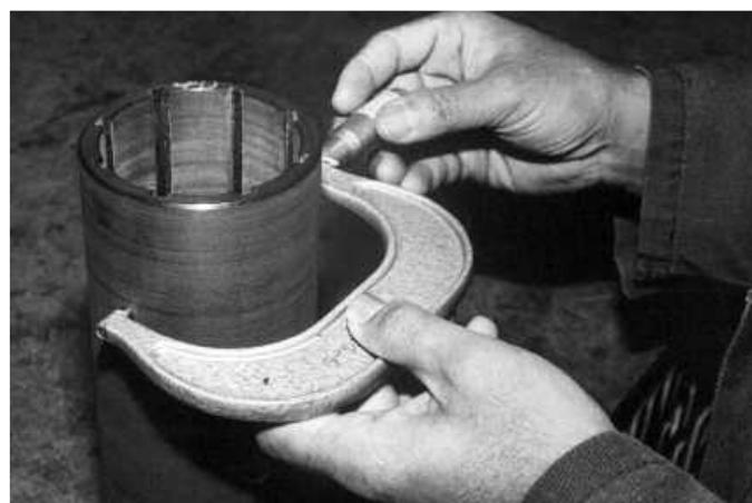
**Slika 21. Mjerenje promjera ležaja [10]**
