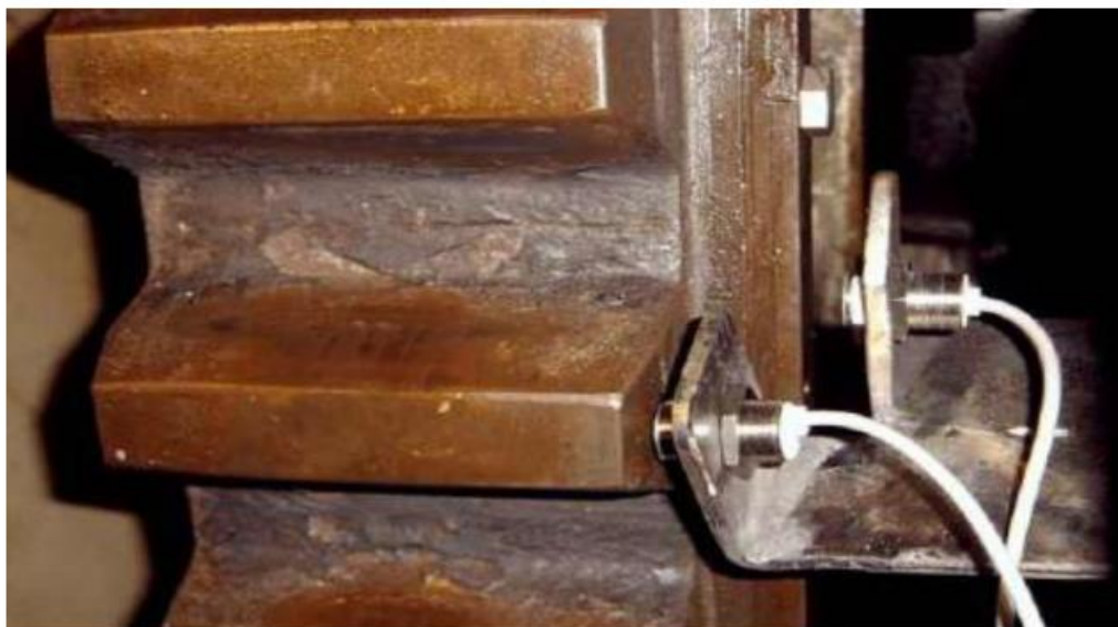
Slika 38. Induktivni pick-up davač brzine vrtnje u načinu rada sa mjerenjem položaja gornje mrtve točke i mjerenje položaja zubaca zamašnjaka [30]
