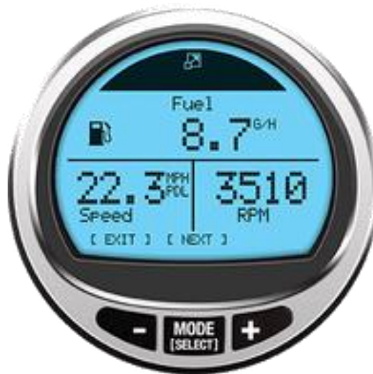
Slika 27. Mjerilo i zaslon Mercury monitora [26]
