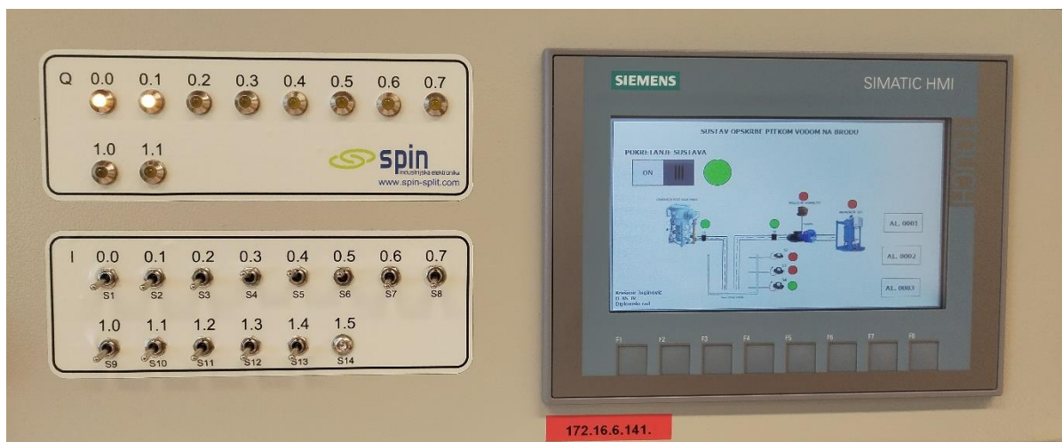
Slika 53. Prikaz sustava kada je tank napunjen te se pali pumpa i ima protoka
