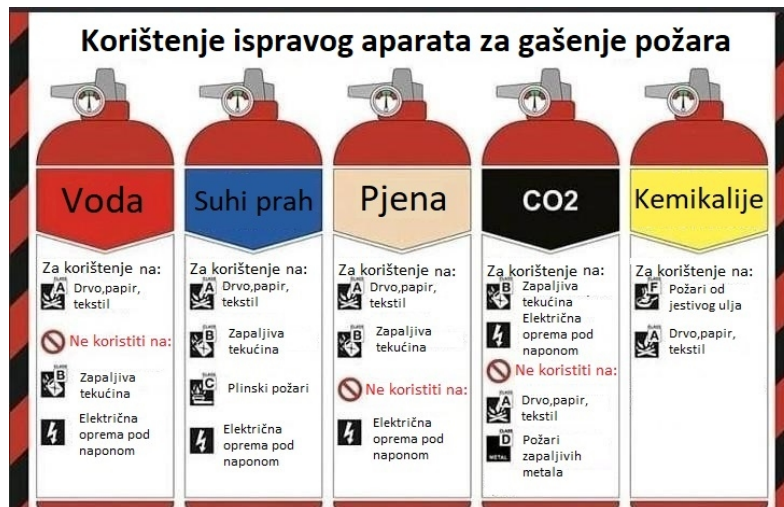
Slika 15. Vrste aparata za gašenje požara [13]
