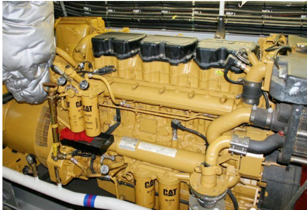
Slika 38. Dizel generatori na brodu Brodospas Beta [40]
