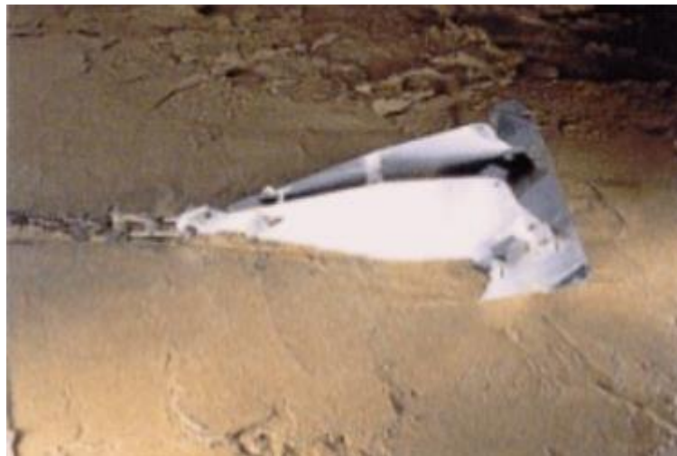
Slika 27. Penetracija sidra u morsko dno [27]
