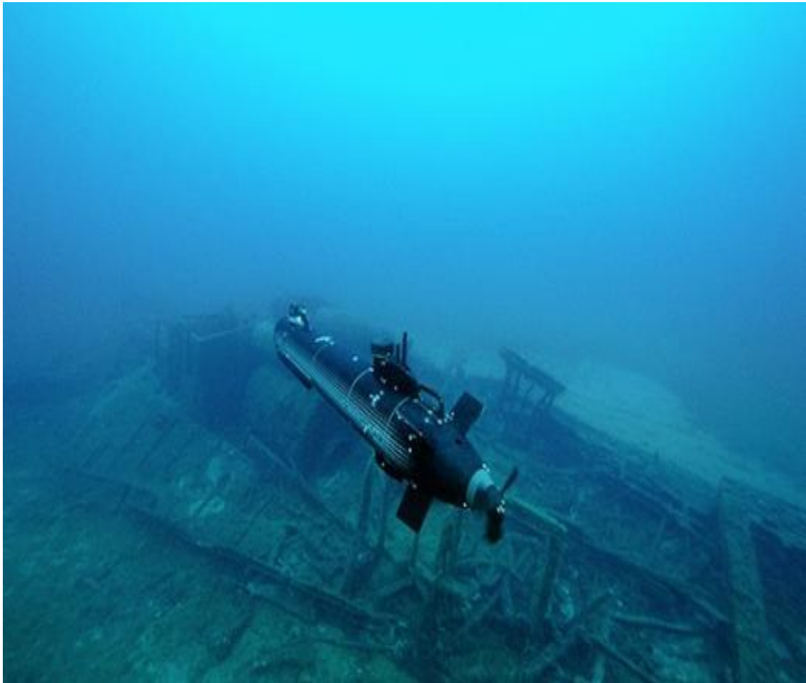
Slika 4. Autonomna podvodna ronilica A9-M [11]
