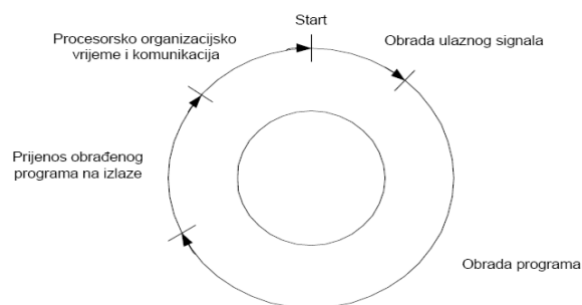
Slika 3 Rad PLC uređaja [5]
