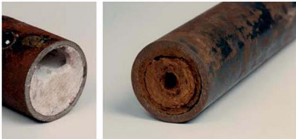
Slika 7. Nakupina kamenca unutar cijevi [10]
