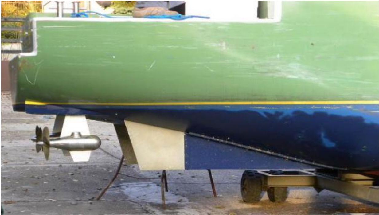
Slika 18. Model LNG tankera opremljen s dva azipoda [3]
