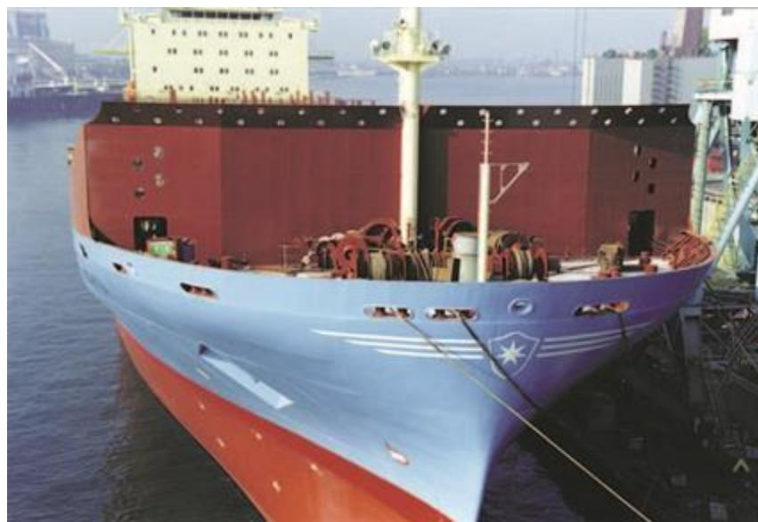
**Slika 3.** Primjer *breakwaterna* [28]
