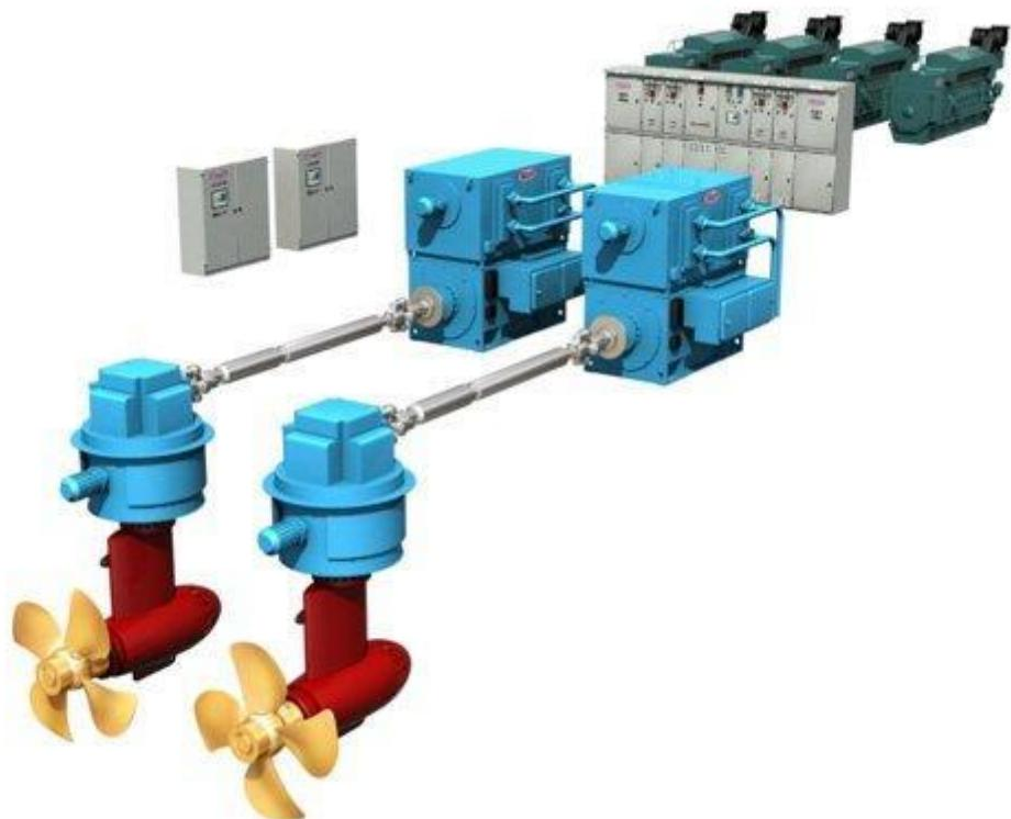
**Slika 5.** Dizel-električna twin propulzija [17]
