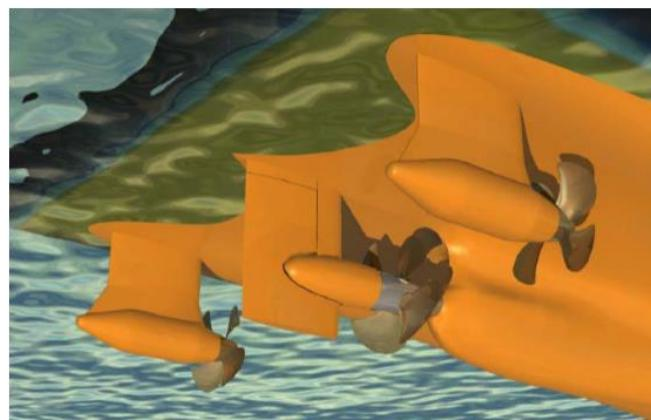
**Slika 10.** Primjer centralnog vijka s dva wing azipoda [5]
