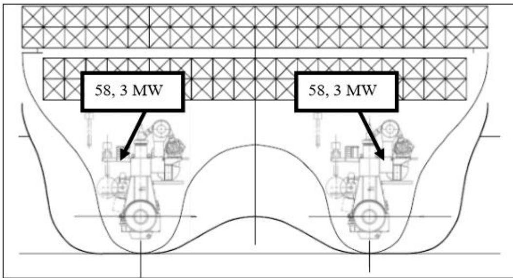
Slika 4. Izgled i raspored twin motora [5]
