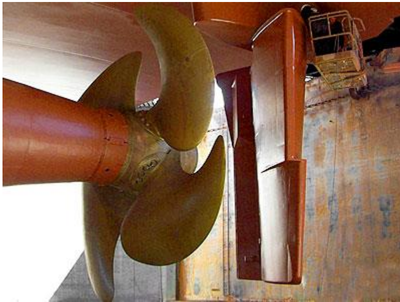
Slika 7. Kormilo s ljuljnim listovima ( twisted rudder ) [9]
