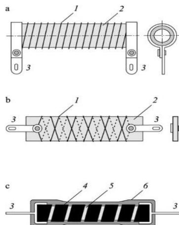
Slika 3 Presjek 3 različita otpornika
