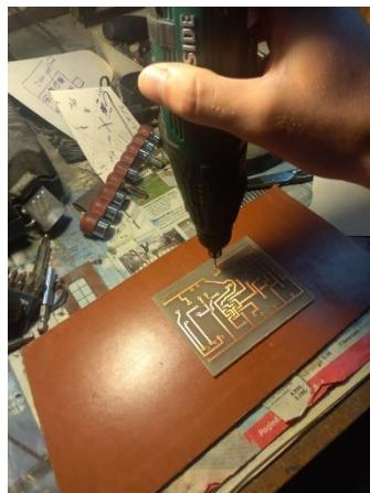
Slika 26 Bušenje rupa na pločici
