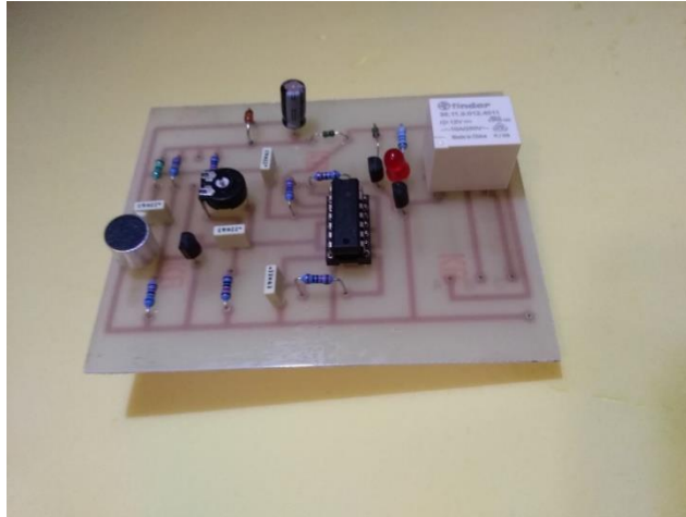
Slika 28 Izgled sastavljene akustične sklopke
