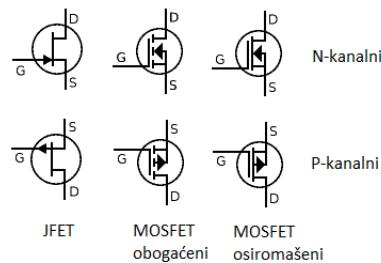
*Slika 10 Unipolarni tranzistor [9]*
