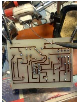
*Slika 27 Lemljenje komponenti na pločicu*
