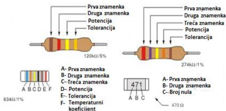
Slika 4 Očitavanje otpornika
