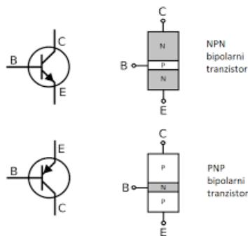
*Slika 11 Bipolarni tranzistor [9]*
