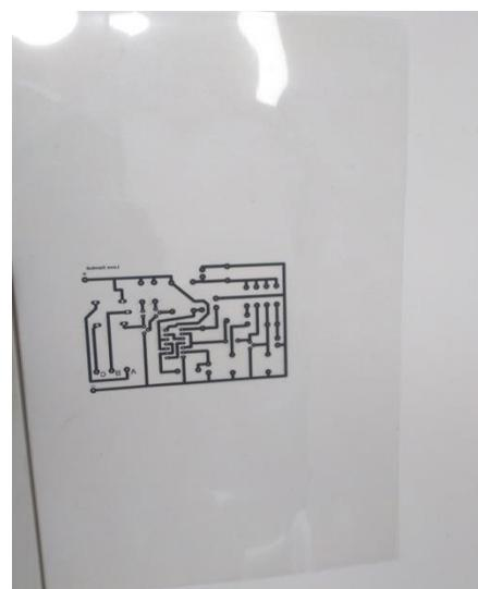
Slika 21 PCB shema na prozirnoj foliji (zrcalno)
