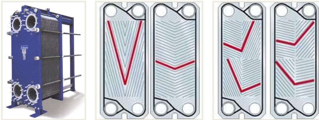
Slika 15. Pločasti izmjenjivač topline i tok strujanja medija [15]
