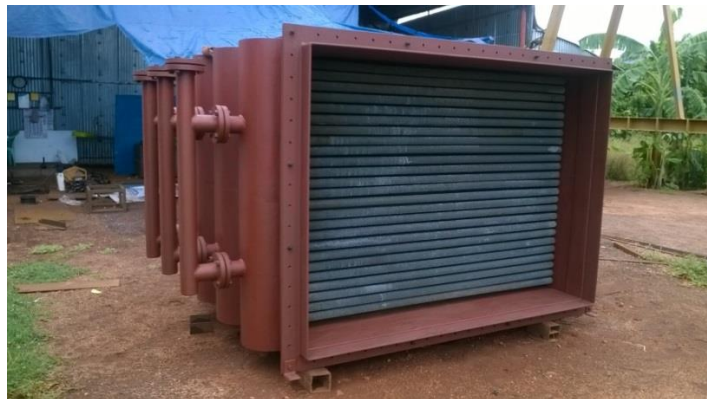
Slika 17. Parni zagrijač zraka [24]
