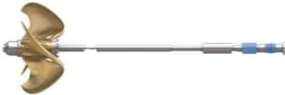
Slika 25. Uređaj za dobavu ulja u osovini [17]
