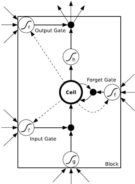
Slika 11. LSTM memorijski blok sa jednom čelijom [21]
