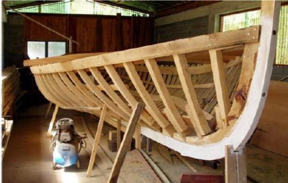
Slika 33. Konstrukcija drvenog broda [30]
