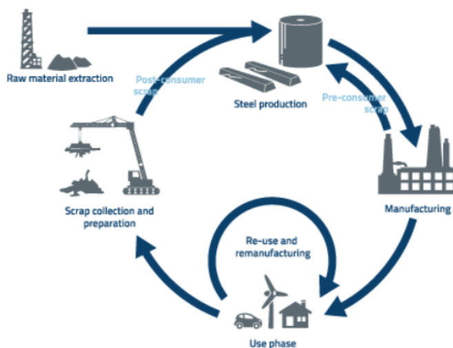
Slika 17. Proces recikliranja čelika [33]
