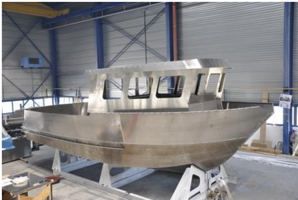
Slika 20. Zavareni aluminijski trup s nadgrađem
