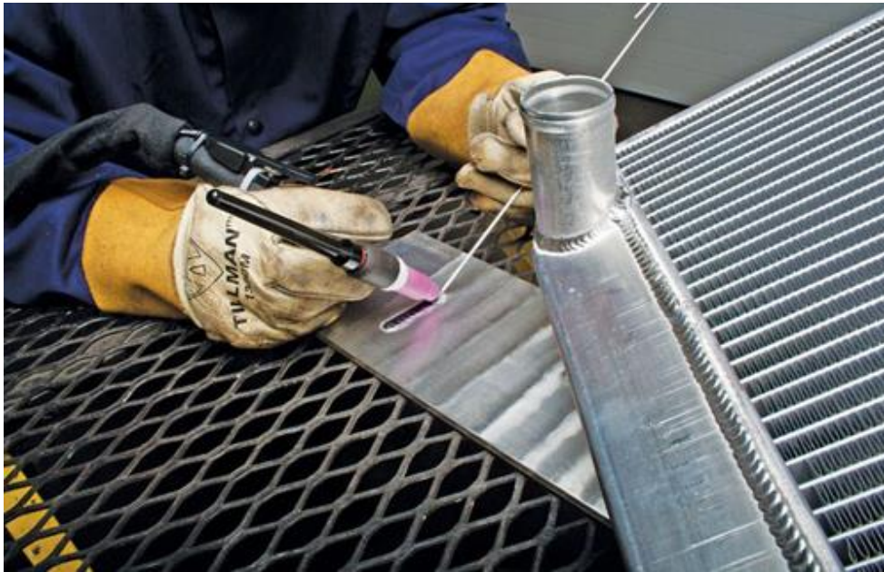
Slika 26. Postupak zavarivanja TIG postupkom (tanki limovi)
