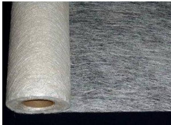
Slika 60. Stakleni mat 400 g/m 2 [30]
