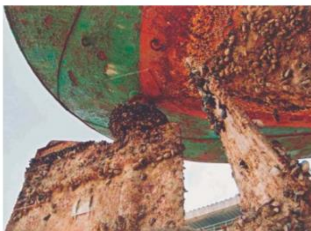
Slika 15. Obraštanje podvodnog dijela broskog trupa [6]
