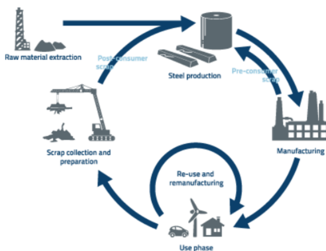
Slika 17. Proces recikliranja čelika [33]
