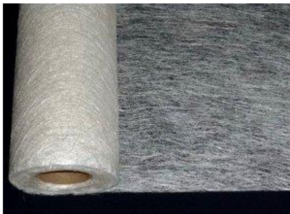
Slika 60. Stakleni mat 400 g/m 2 [30]
