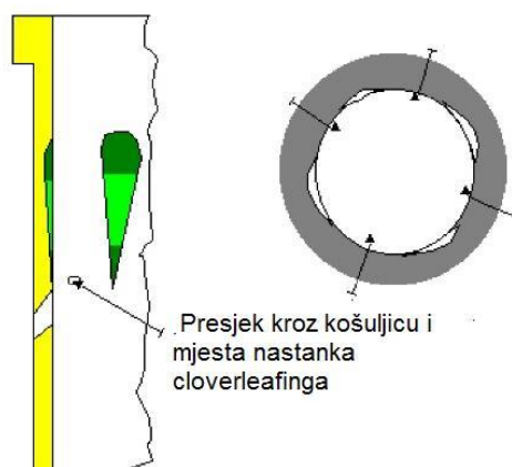
Slika 25. Mjesta nastanka istrošenja [2]
