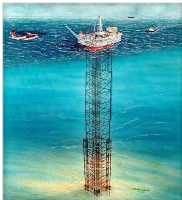
Slika 17. Prikaz odobalna naftna platforma s fleksibilnim tornjem [6]
