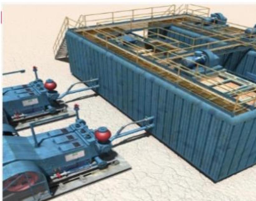
Slika 48. Cirkulacijski sistem isplake [13]
