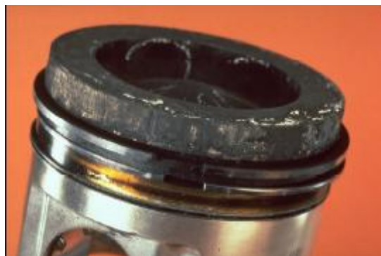
Slika 25. Abrazivno trošenje zbog naslage ugljika na vrhu klipa [7]
