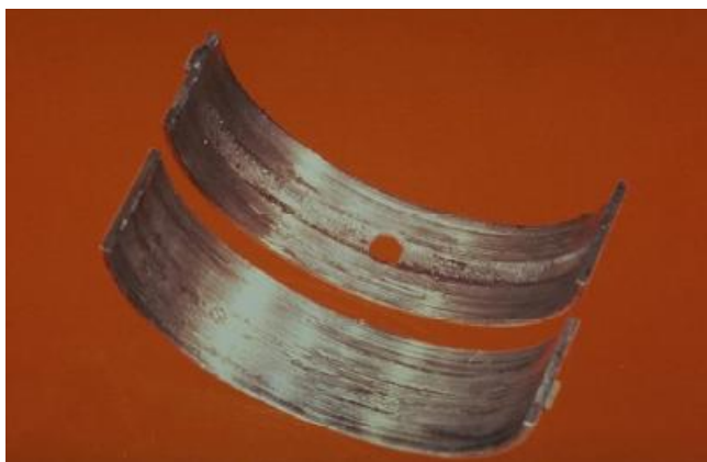
Slika 29. Adhezijsko trošenje do aluminijskog sloja [6]
