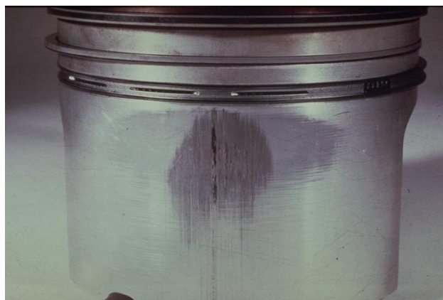
Slika 21. Adhezijsko trošenje kod hladnog starta [7]
