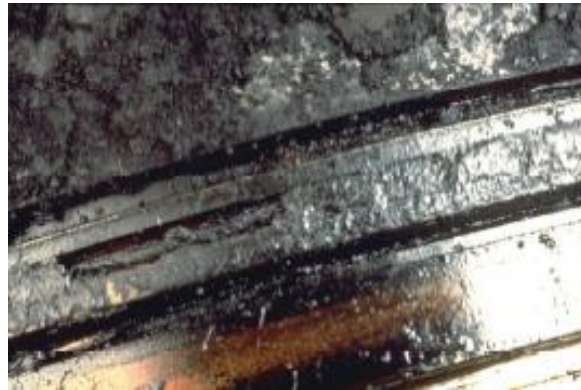
Slika 24. Nakupine ugljika u kanalima za kompresijske prstenove [7]
