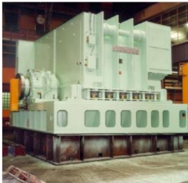
Slika 6: Izmjenični propulzijski motor [8]
