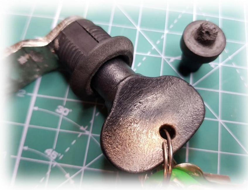
Slika 54. Cilindar brave električnog ormarića
