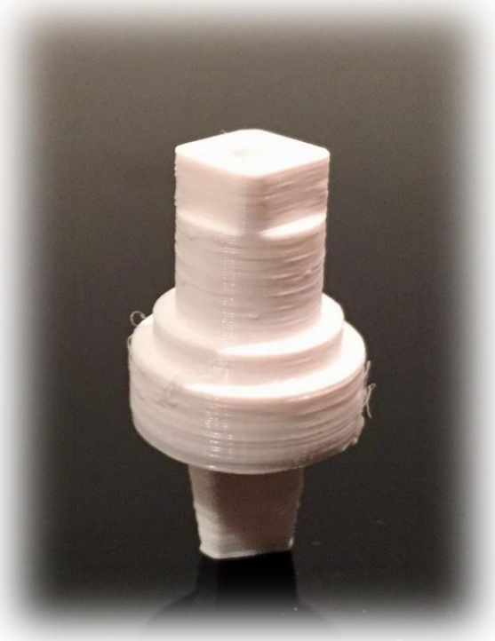
Slika 55. Cilindar brave električnog ormarića izrađen FDM tehnologijom
