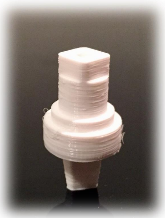
Slika 55. Cilindar brave električnog ormarića izrađen FDM tehnologijom
