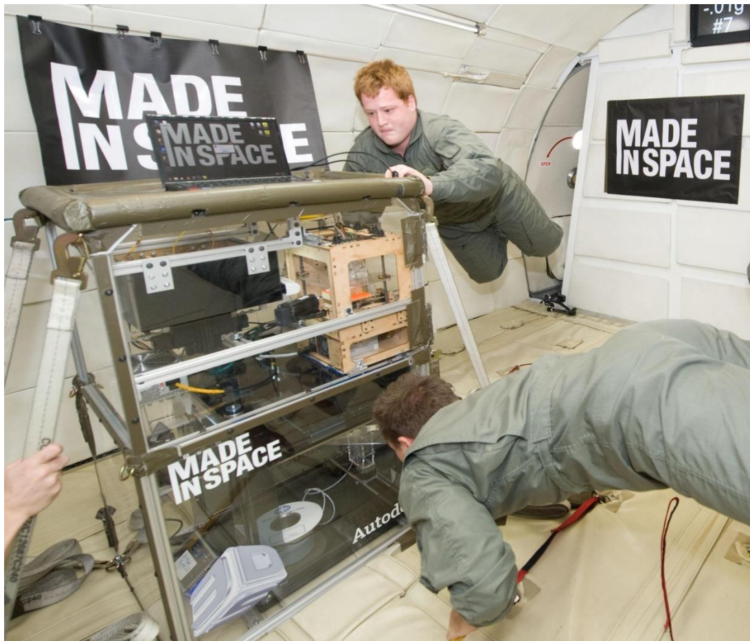
Slika 22. Izrada potrebnog alata u svemiru uz pomoć FDM 3D tehnologije [9]
