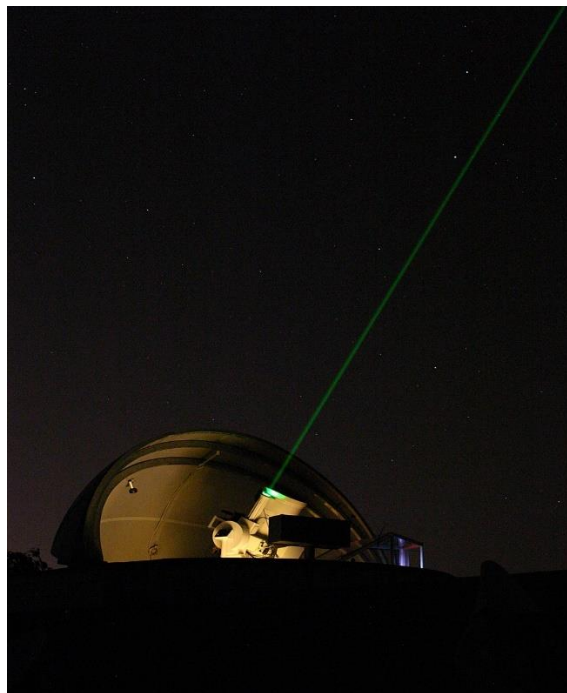
Slika 2. Laserski impuls odaslan sa Zemlje prema pasivnom satelitu Izvor: [8]
