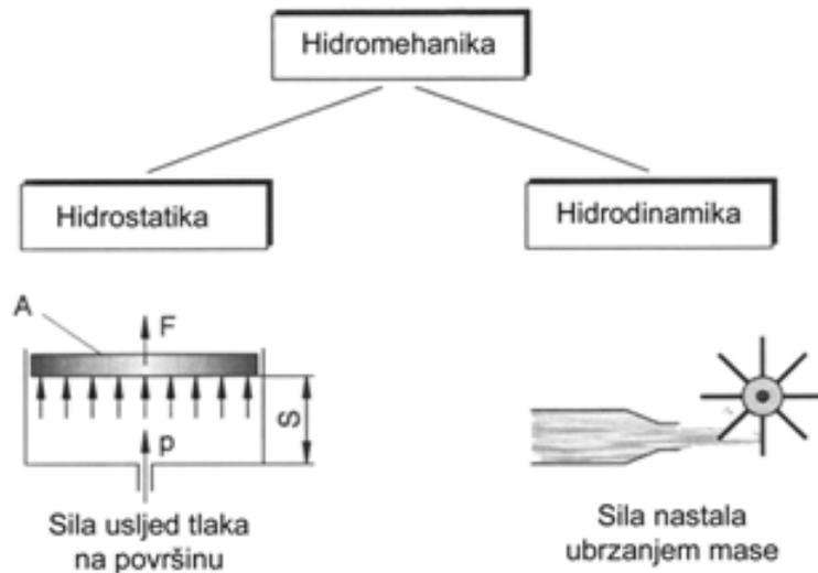
Slika 6. Podjela hidromehanike [8]
