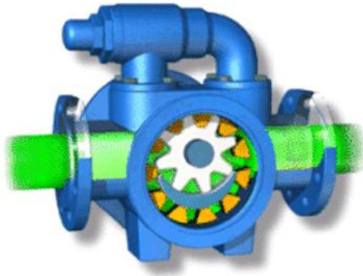
**Slika 16. Zupčasta pumpa s unutarnjim ozubljenjem [2]**
