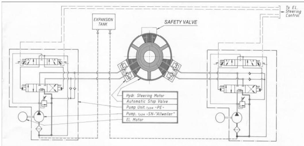
Slika 32. Shema spajanja krilnog hidrauličkog kormilarskog stroja s pogonskim agregatima [3]
