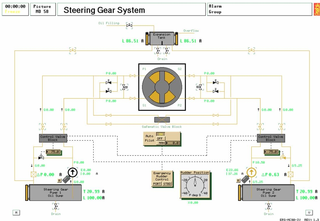
Slika 30. Shema sustava krilnog kormilarskog uređaja [6]
