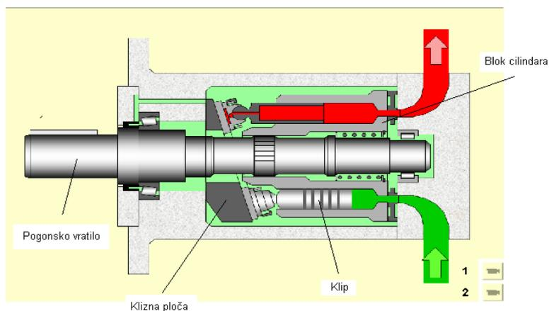
**Slika 19. Klipno-aksijalna pumpa s nagibnom pločom [2]**
