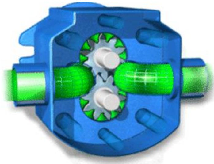
Slika 15. Zupčasta pumpa s vanjskim ozubljenjem [2]
