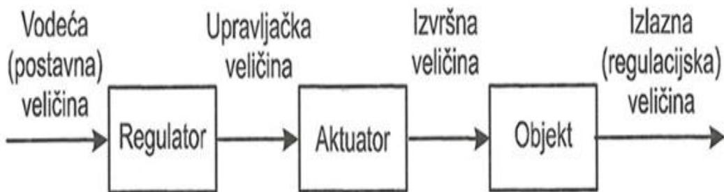
**Slika 4. Blok dijagram otvorenog sustava upravljanja [4]**
