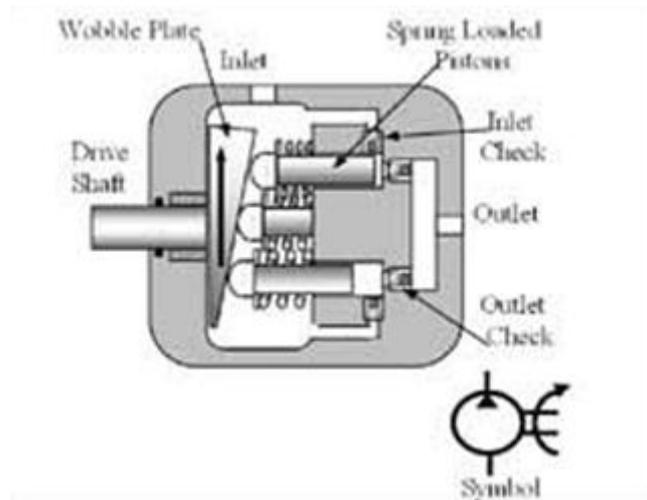
Slika 20. Klipno-aksijalna pumpa s zaokretnom pločom [2]
