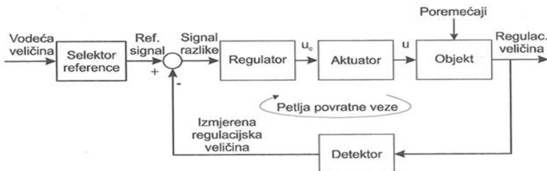
**Slika 5. Blok dijagram sustava upravljanja u zatvorenom krugu [4]**
