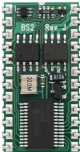
Slika 1. BASIC Stamp 2 mikrokontroler [1]
