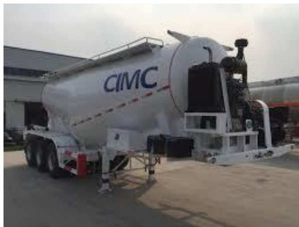
Slika 7. Cisterna za prijevoz cementa [17]
