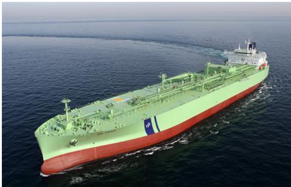
Slika 2. LPG brod za prijevoz polu rashlađenog plina [8]
