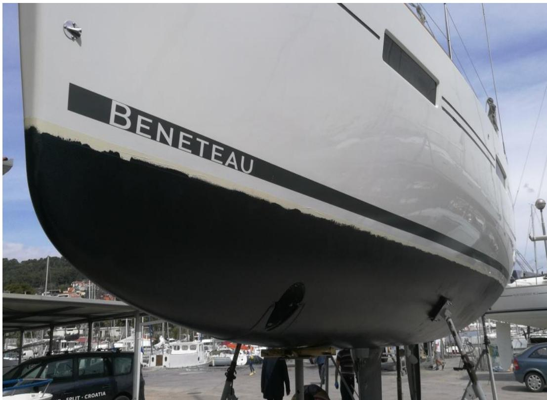
**Slika 5. Novi protuobraštajni premaz**
