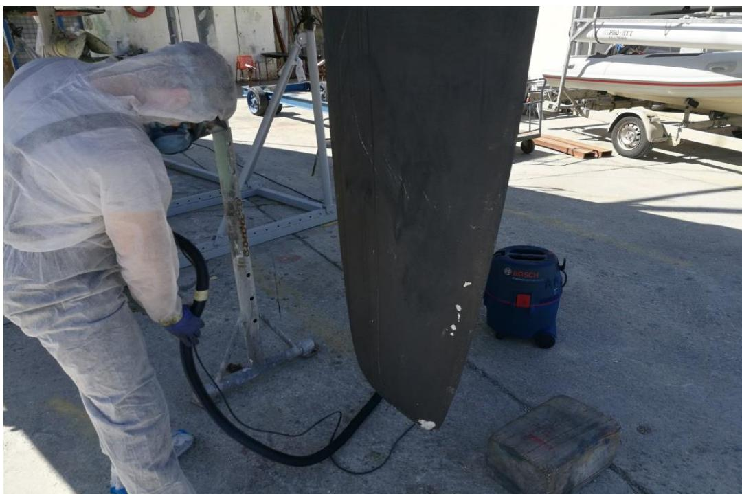
**Slika 2. Brušenje s prikladnom opremom**
