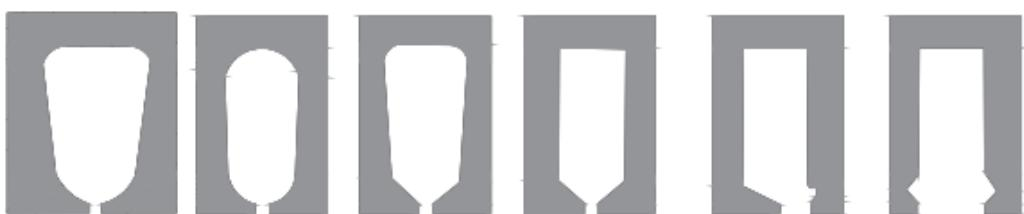
**Slika 3. Oblici statorskih utora asinkronog motora [5]**
