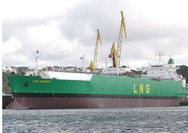
Slika 7. LNG tanker membranskog tipa [18]
