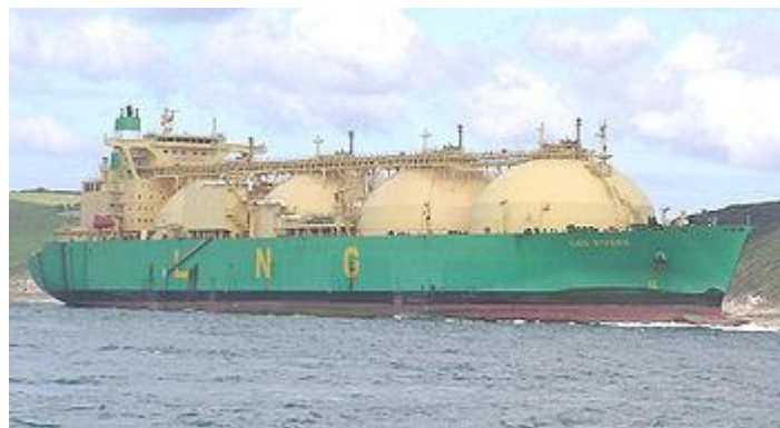
Slika 8. LNG brod sa samonosivim spremnicima [18]
