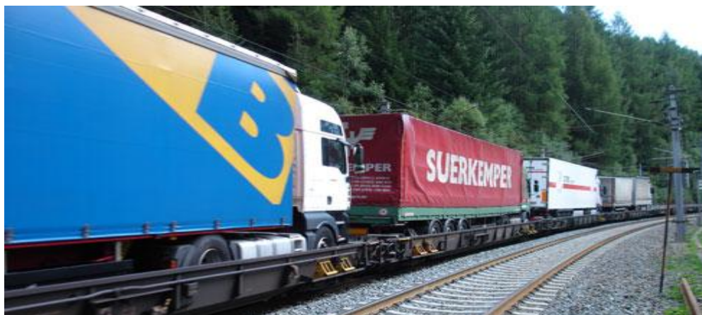
Slika 13. Huckepack A tehnologija transporta [13]
