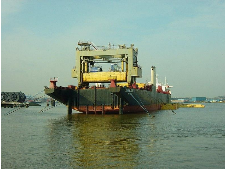
Slika 7. Krmeni dio LASH broda s mosnom dizalicom [11]
