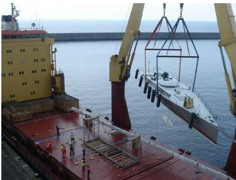
Slika 5. Tehnologija ukrcanja/iskrcanja tereta u LO – LO sustavu [9]
