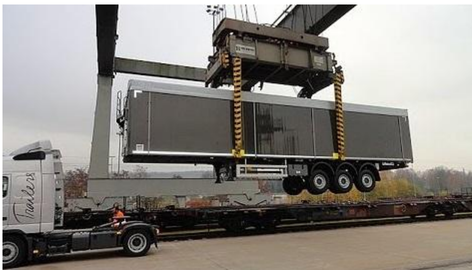
Slika 14. Vertikalni ukrcaj poluprikolice u Huckepack B sustavu [14]
