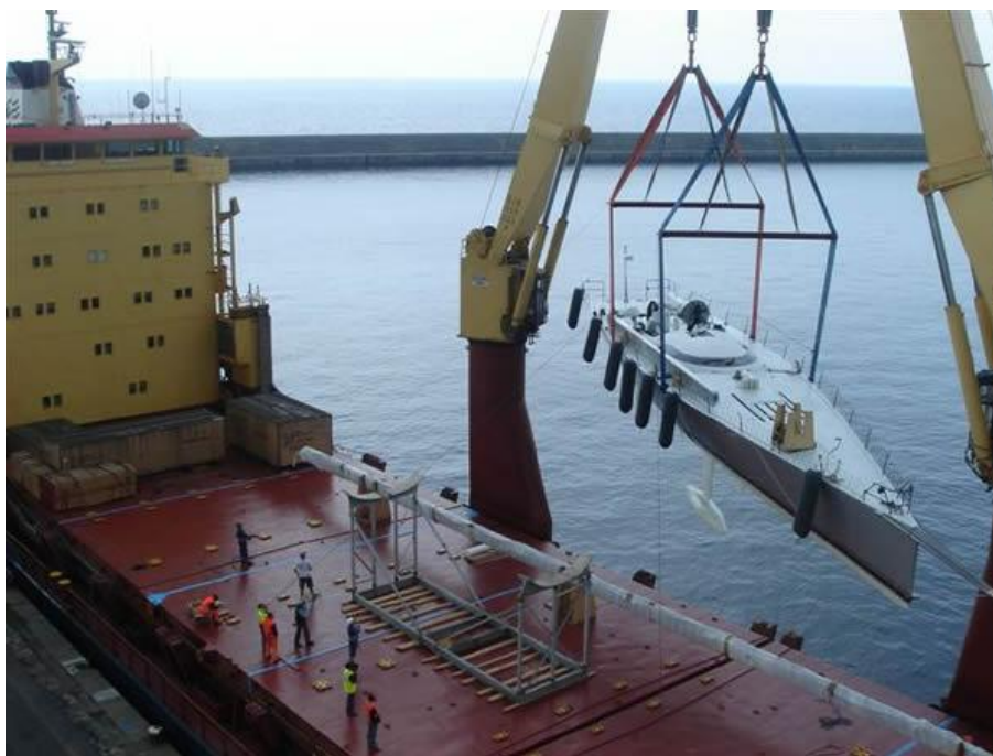
Slika 5. Tehnologija ukrcanja/iskrcanja tereta u LO – LO sustavu [9]
