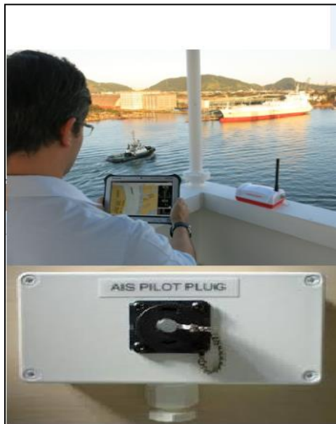
Slika 31. Prijenosna pilotska jedinica [40]
