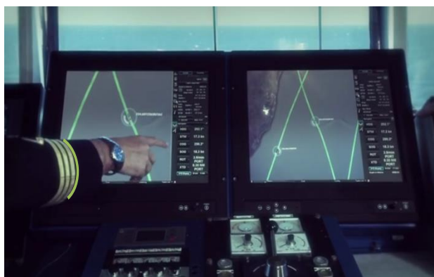
Slika 24. Prikaz plovidbenih ruta drugih brodova na vlastitom ECDIS zaslonu [35]
