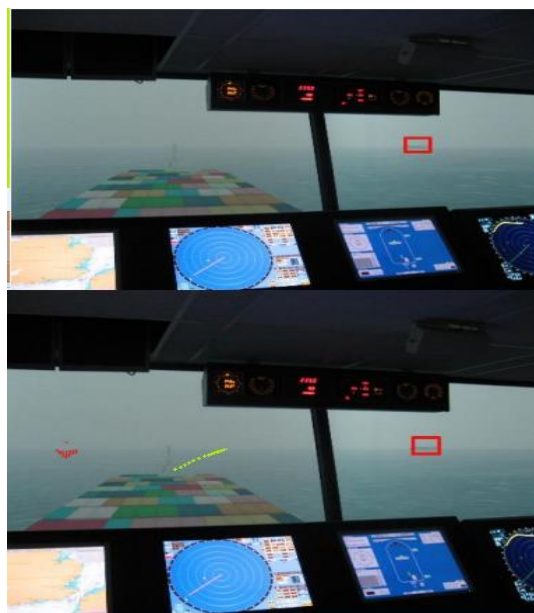
Slika 8. „Uvećana stvarnost“ na simulatoru [6]
