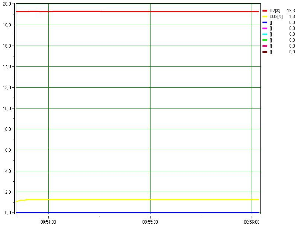
Slika 27. Grafički prikaz O 2 i CO 2 za lijevi motor
