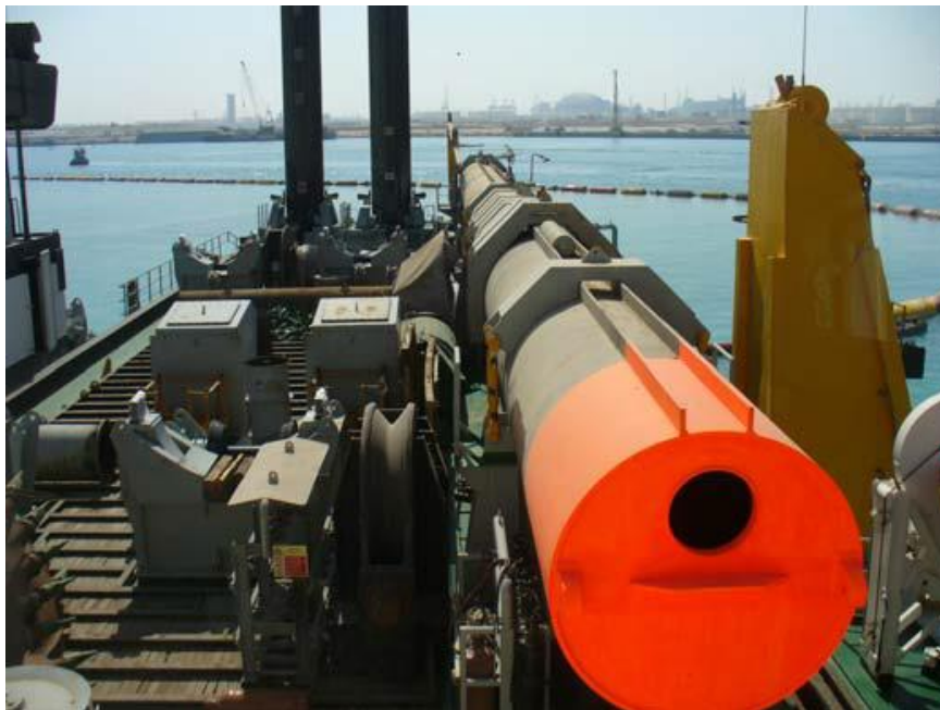
Slika 63. Glavni i pomoćni pilon u uspravnom položaju, rezervni u položaju morskog veza [9]
