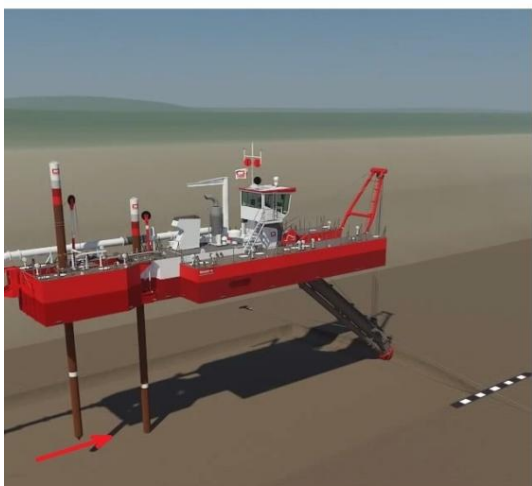
Položaj 5 - nakon što je glavni pilon podignut, a pomoćni spušten, kolica se počinju gibati prema naprijed dok ne dođu u krajnji položaj (najbliže sjekaču), a zatim se glavni pilon ponovo spušta, a pomoćni podiže.
