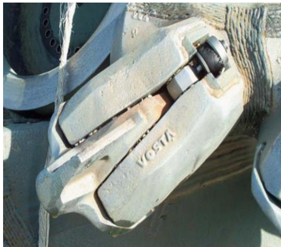
Slike 59. i 60. VOSTA adapter za zube (lijevo) i Royal IHC CB sustav zuba (desno) [10]
