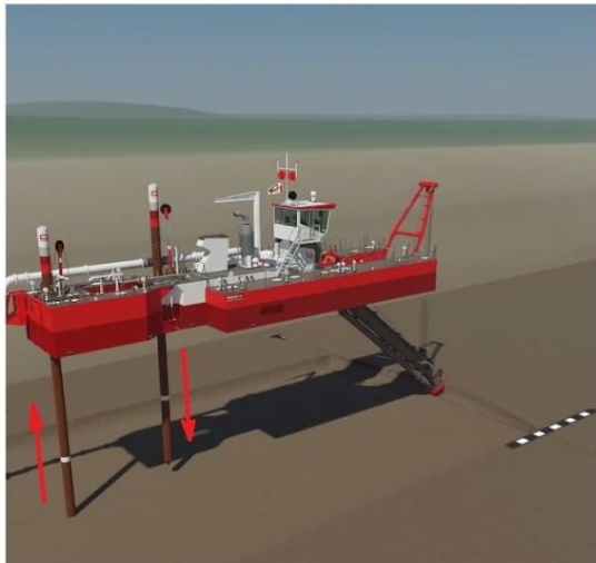
Položaj 4 - nakon što su kolica pilona došla u krajnji položaj, brod se više ne može odgurivati prema naprijed. Potrebno je spustiti pomoćni pilon kako bi brod ostao na mjestu, dok se pilon u kolicima podiže.
