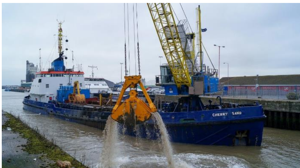
Slika 35. Cherry Sand jaružalo grabiličar s vlastitom propulzijom [18]
