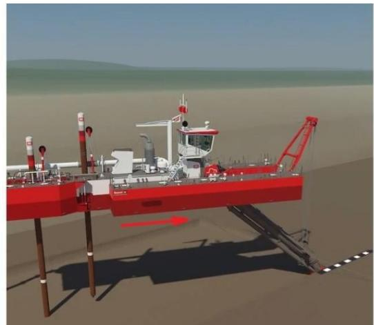
**Položaj 2** - sjekač se nalazi u krajnjem desnom položaju, prvi je kružni luk opisan. Jaružar se kreće pomicati prema naprijed "odgurujući" se od kolica pilona.
