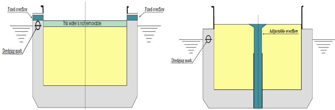
**Slika 67. Sustav stalnog volumena (lijevo) i sustav stalne tonaze (desno) [6]**
