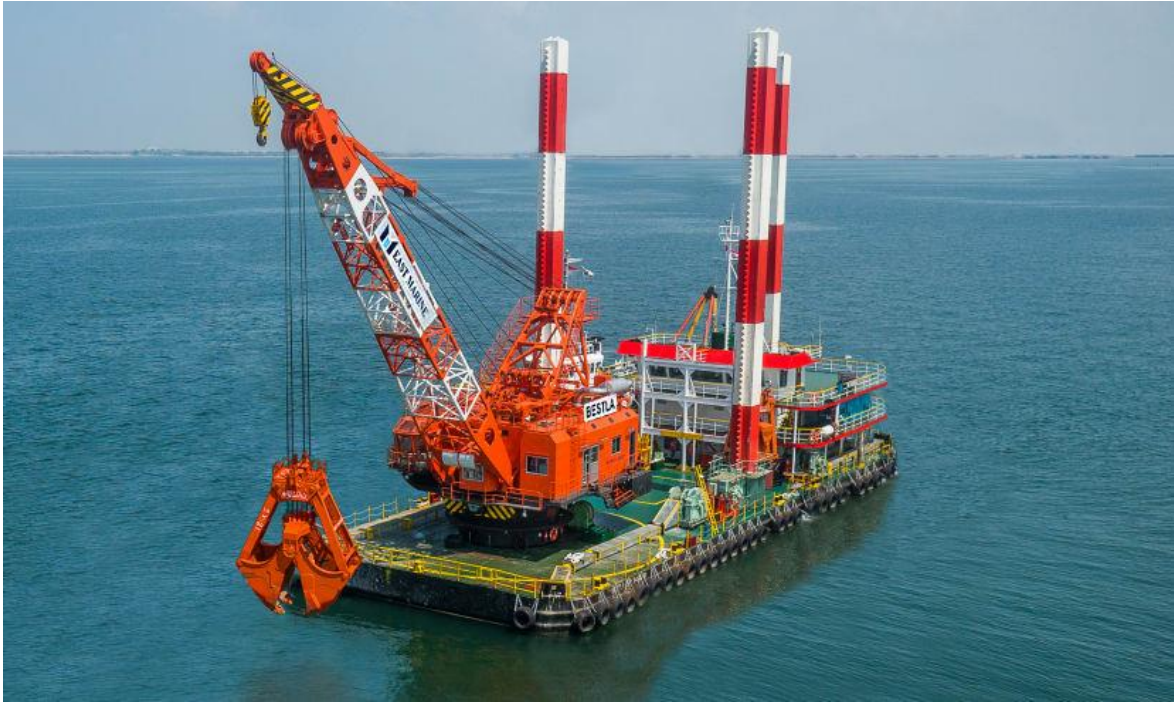
Slika 29. Jaružalo s grabilicom pontonskog tipa [24]
