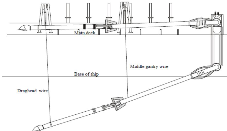
**Slika 66. Spuštanje usisne cijevi [6]**
