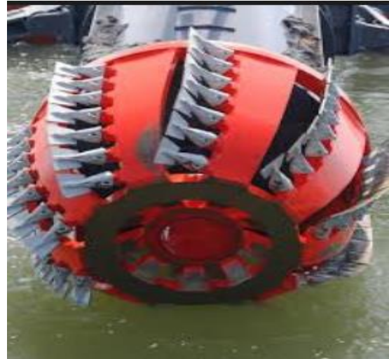
Slike 57. i 58. rezač za meko kamenje (lijevo) i višenamjenski Lancelot® rezač (desno) kompanije IHC Royal [13]
