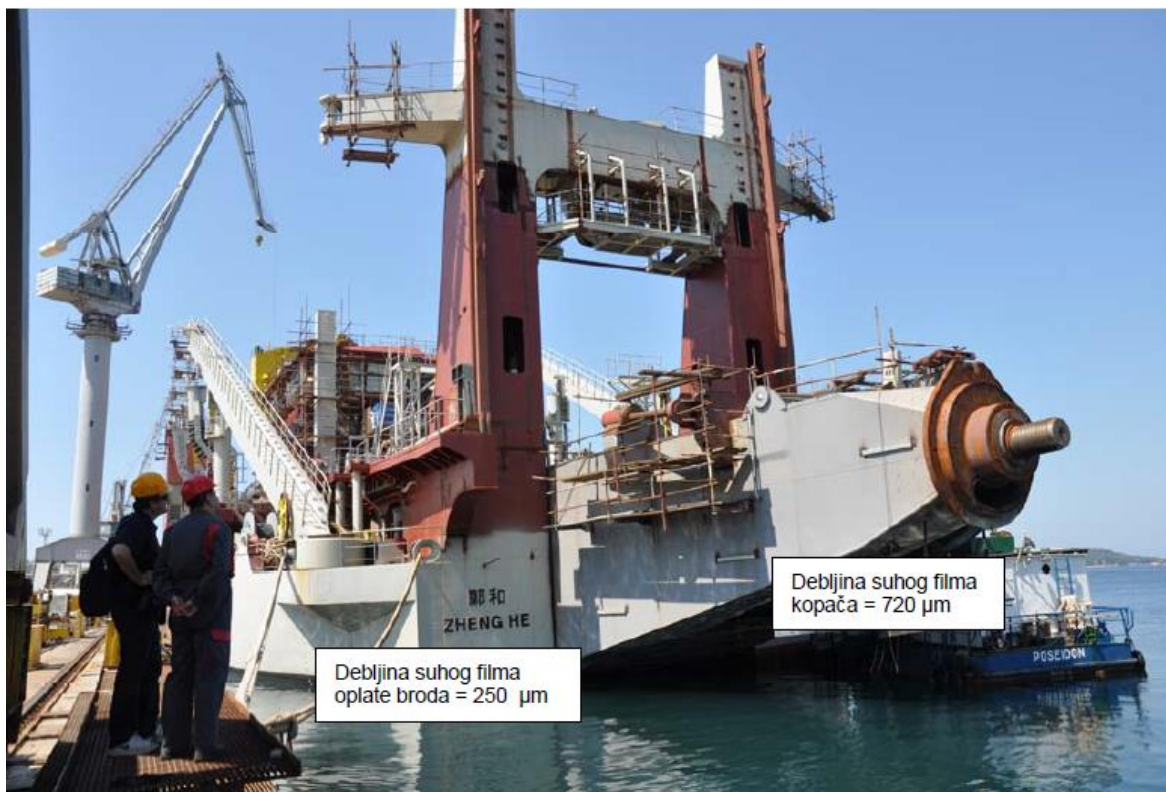
Slika 84. Obojano jaružalo Zheng He , Brodogradilište Uljanik, Pula [1]
