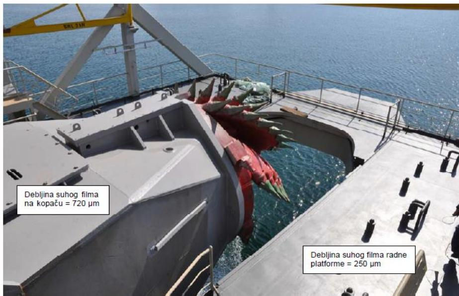
**Slika 85. Kopač zaštićen silikonskim premazom,
