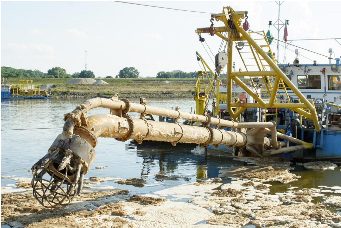
Slika 38. Usisna usta običnog usisnog jaružala [21]
