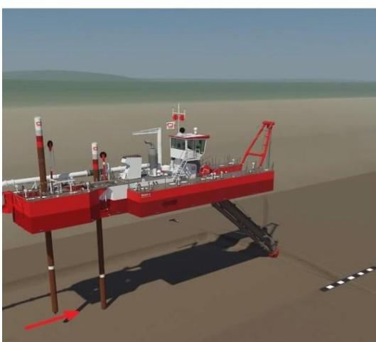
**Položaj 5** - nakon što je glavni pilon podignut, a pomoći spušten, kolica se počinju gibati prema naprijed dok ne dodu u krajnji položaj (najblže sjekaču), a zatim se glavni pilon ponovo spušta, a pomoći podiže.
