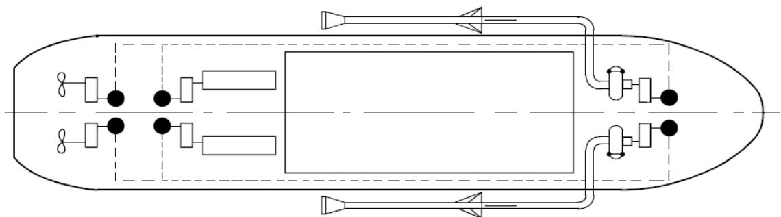
**Slika 77. Dizel-električna propulzija [6]**
