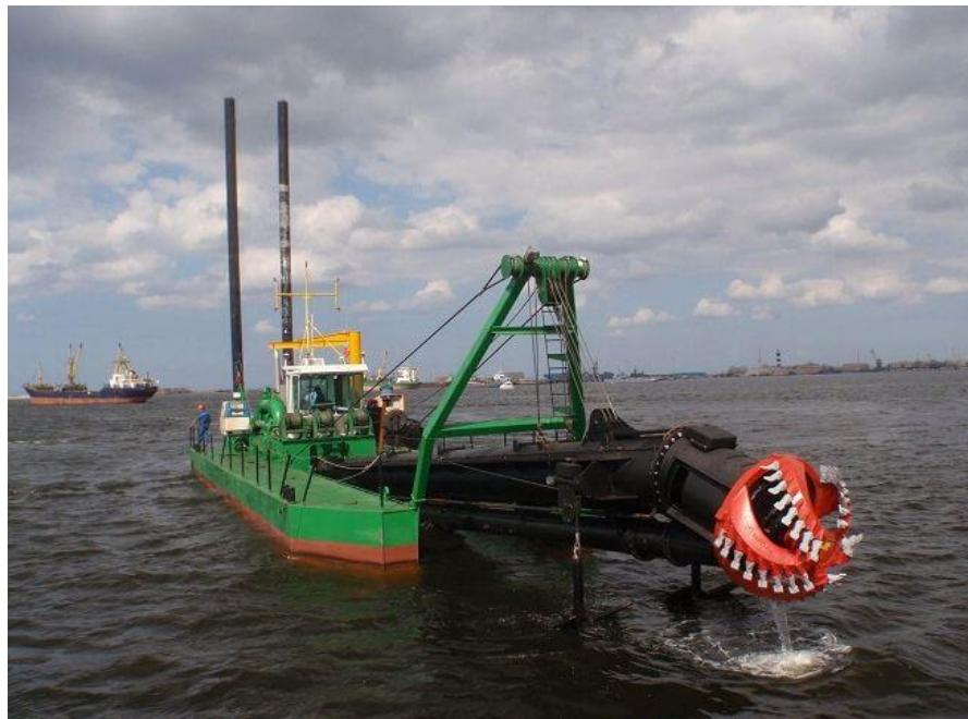
Slika 9. Usisno jaružalo s rezačem [39]
