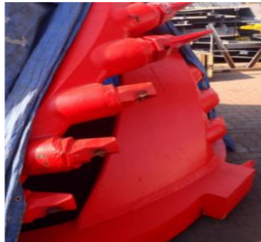
Slike 59. i 60. VOSTA adapter za zube (lijevo) i Royal IHC CB sustav zuba (desno) [10]
