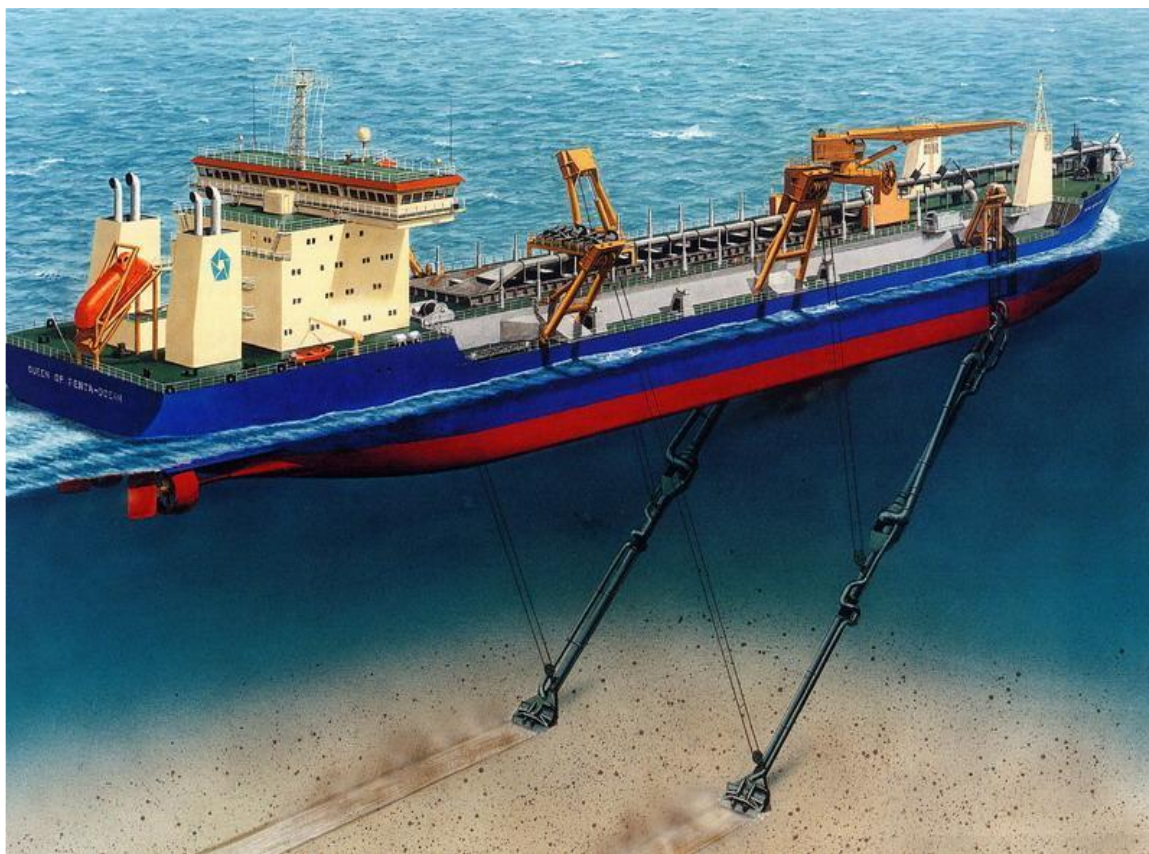
Slika 8. Usisno jaružalo sa skladištem [8]
