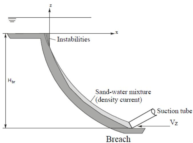
Slika 37. Princip rada običnog usisnog jaružala [6]
