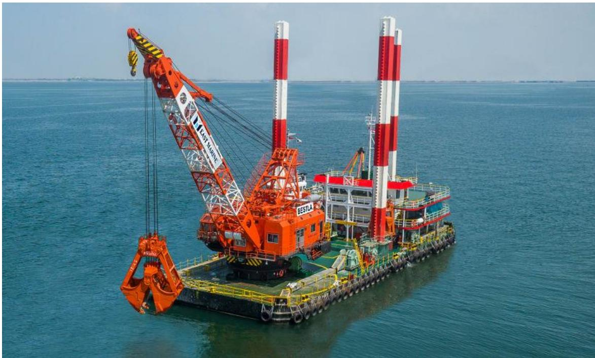
**Slika 29. Jaružalo s grabilicom pontonskog tipa [24]**
