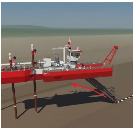
**Položaj 3** - glavni je pilon za uzdužni pomak broda udaljeniji od glave sjekača (veći radijus) i zatezanjem lijevog čeličnog kabela, počinje se opisivati novi koncentrični kružni luk. Proces se ponavlja dok kolica pilona ne dodu u krajnji položaj.
