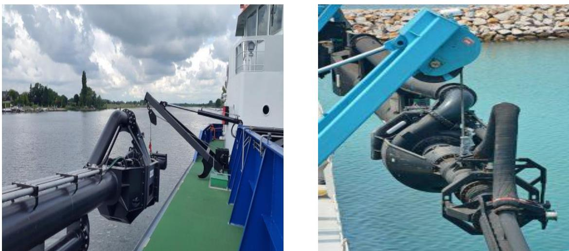
Slike 79. i 80. Pogonski sklop podvodne pumpe u usisnoj cijevi [32]
