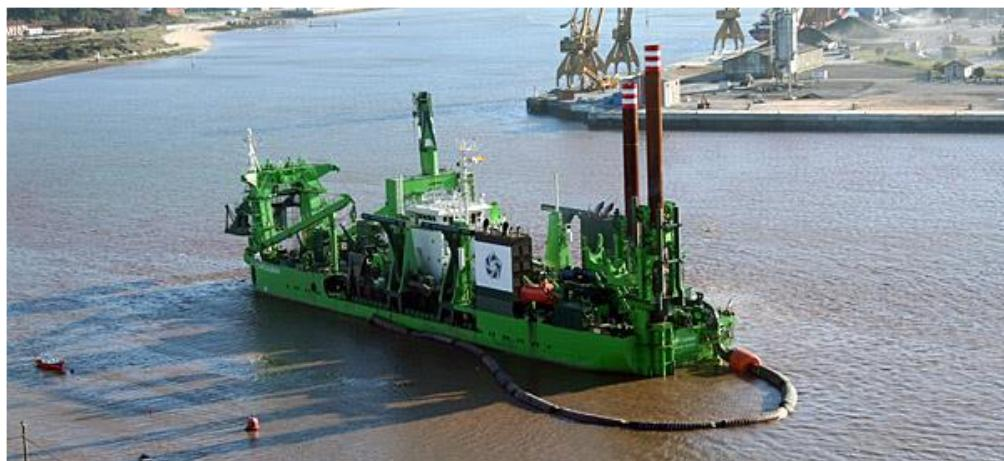
**Slika 3. Iskrcaj iskopanog tereta preko plutajućeg cjevovoda [9]**
