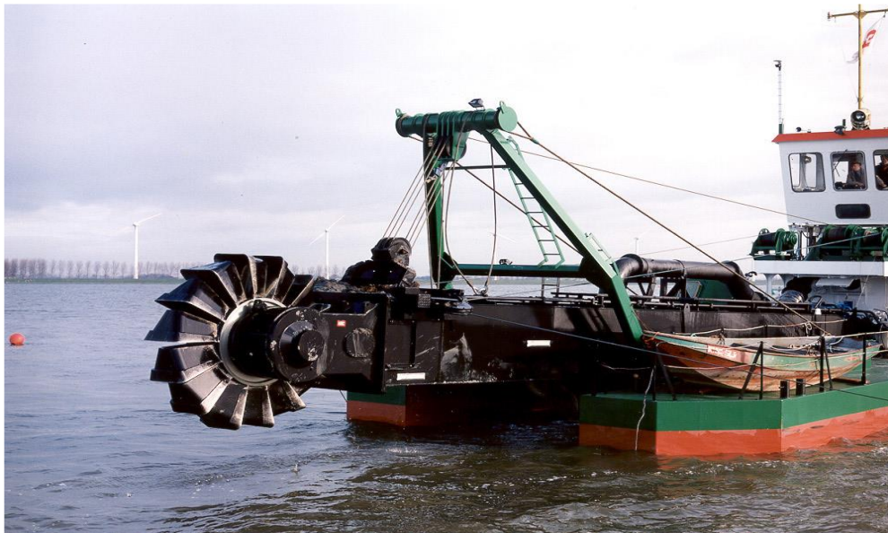
Slika 18. Vedričar s rotirajućim kolom [22]
