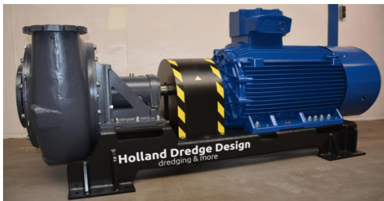
Slika 41. Horizontalna pumpa za jaružanje Holland Dredge Design [31]
