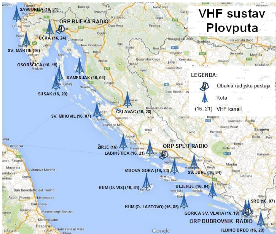
Slika 7. Prikaz VHF obalnih radio stanica Plovoputa u RH [12]
