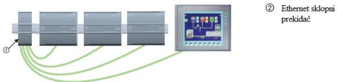
Slika 8. Primjer spajanja više CPU-ova i HMI-a pomoću ethernet sklopnog prekidača [1]
