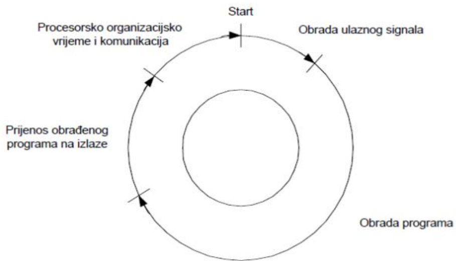
Slika 15. Princip rada PLC-a [6]
