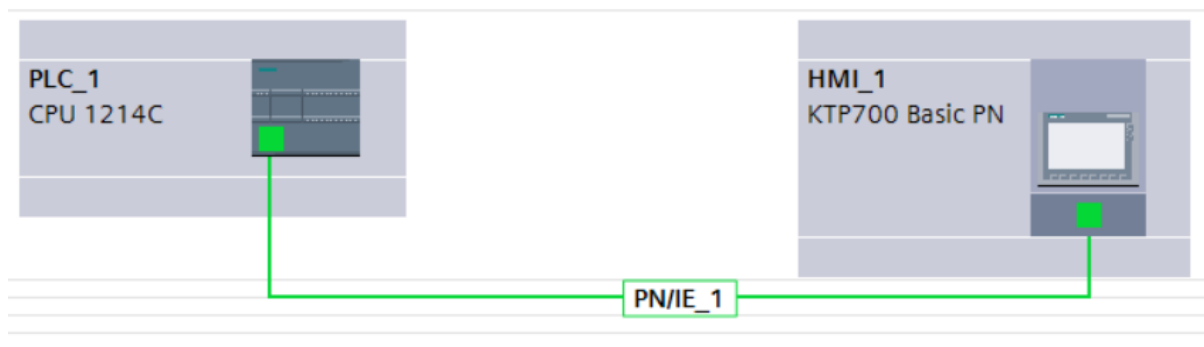
Slika 30. Prikaz povezanog PLC-a i HMI-a preko PROFINET-a
