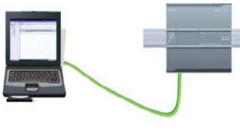
Slika 5. Komunikacija PLC-a i računala [1]
