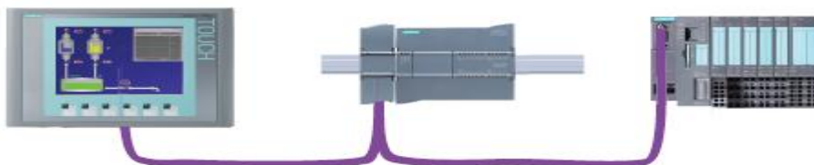
Slika 10. S7-1200 spojen kao nadređeni uređaj koja upravlja ET200S [1]
