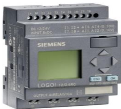
Slika 16. Primjer SIEMENS-ovog PLC-a s funkcijskim tipkama [3]
