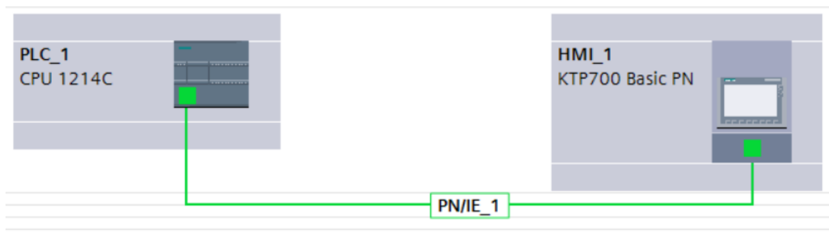
Slika 30. Prikaz povezanog PLC-a i HMI-a preko PROFINET-a
