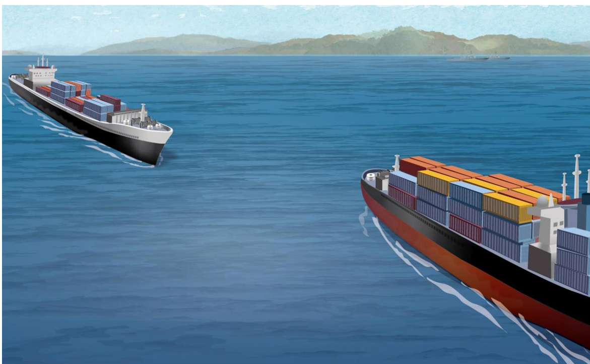
Slika 12. MIMOILAŽENJE brodova – utjecaj „vodenog jastuka“ [11]
