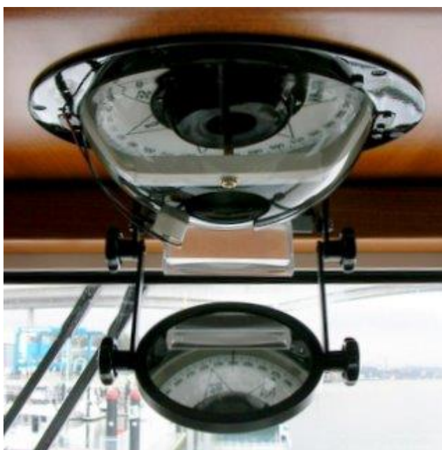
Slika 11. Kompas ugrađen na strop kormilarnice [15]
