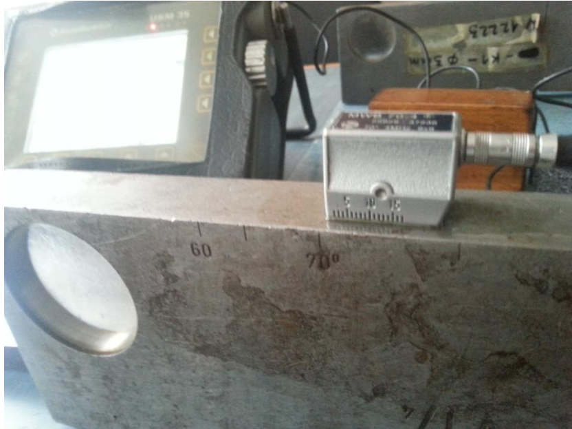
Slika 34. Određivanje kuta sonde
