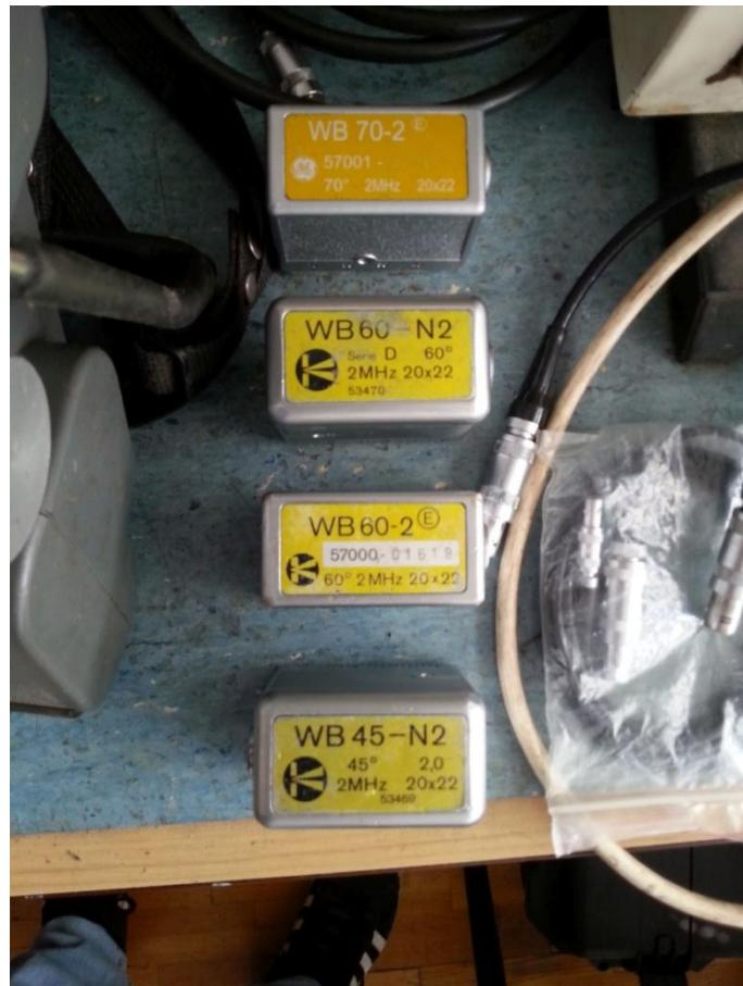
Slika 26. Kutne sonde Wb 45-2, WB 60-2, WB 70-2
