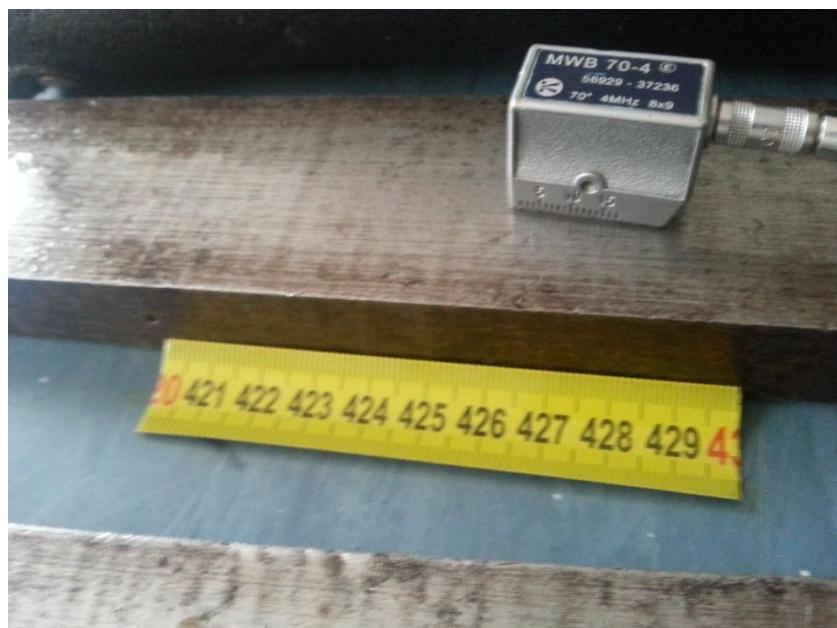
Slika 32. Očitavanje udaljenosti izlazne točke sa mjerne trake
