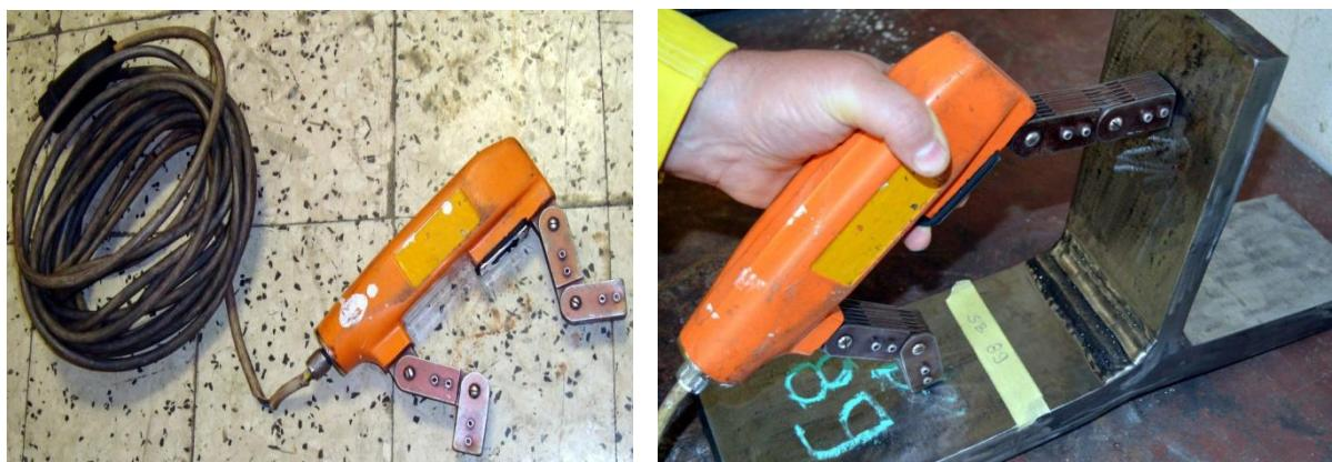
Slika 3. Elektrodni magnetoskop kojim se magnetizira površina [4, 8]
