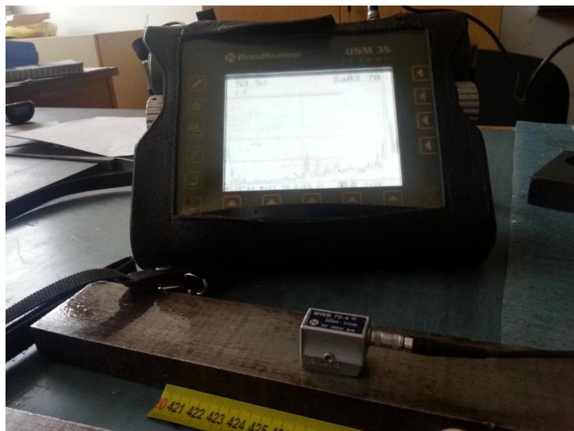
Slika 30. Priprema za određivanje izlazne točke
