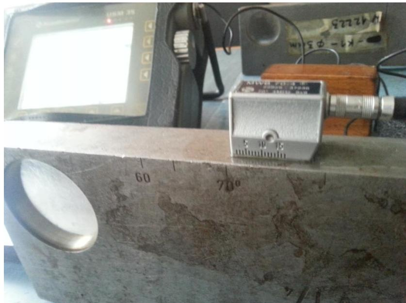
Slika 34. Određivanje kuta sonde
