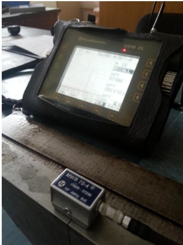
Slika 33. Određivanje izlazne točke na etalonu V1
