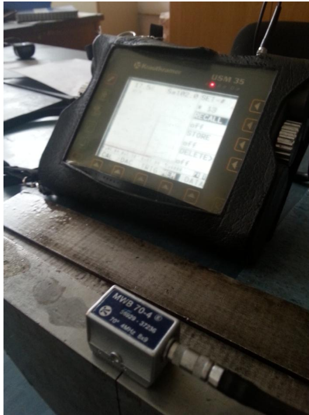
Slika 33. Određivanje izlazne točke na etalonu V1
