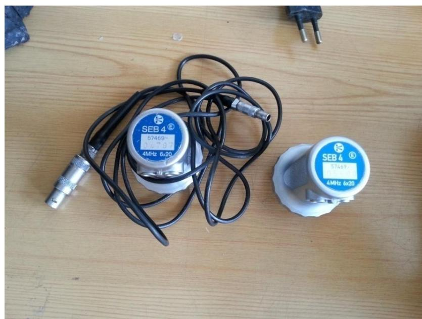
Slika 24. Sonda sa dva pretvarača. Model SEB 4
