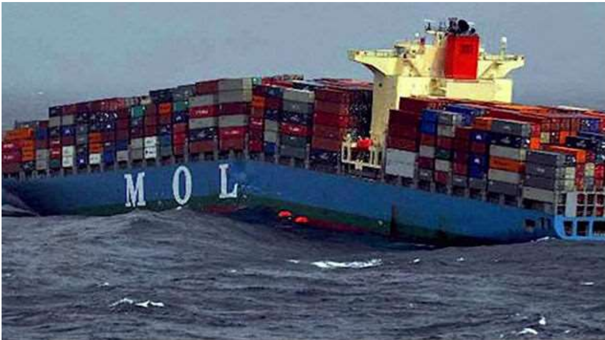
Slika 4. Na pola napuknuti brod MOL Comfort nedugo nakon nesreće [11]
