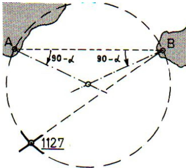
**Slika 14. Pozicija određena s horizontalnim kutom i azimutom [9]**
