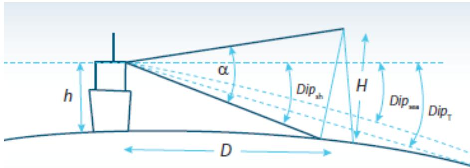
**Slika 3. Vertikalni kut kada je objekt unutar morskog horizonta [10]**
