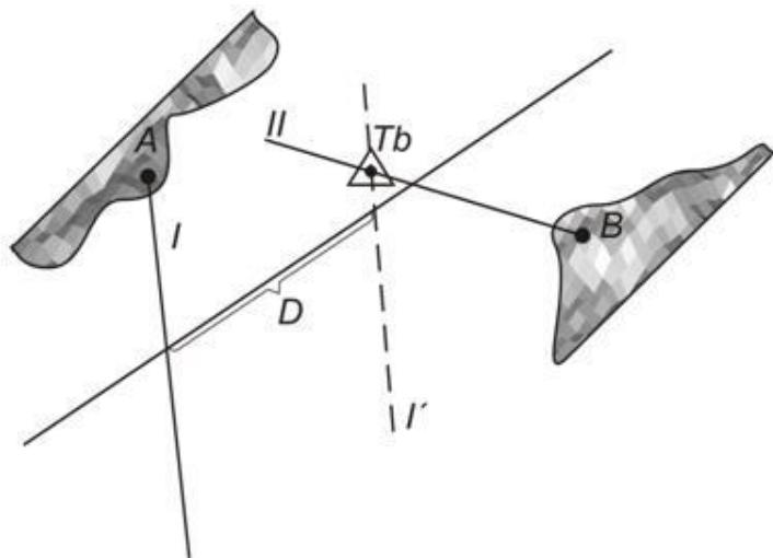
**Slika 26. Pozicija broda u razmaku vremena s dva azimuta na dva objekta [6]**
