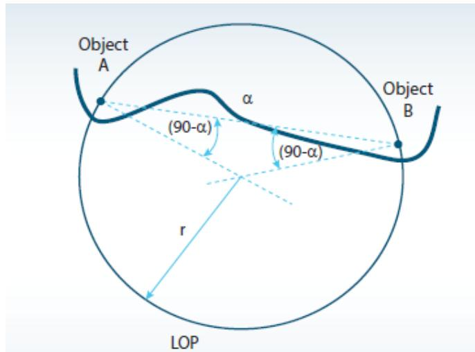
**Slika 6. Grafički izračun stajnice pomoću horizontalnog kuta [10]**
