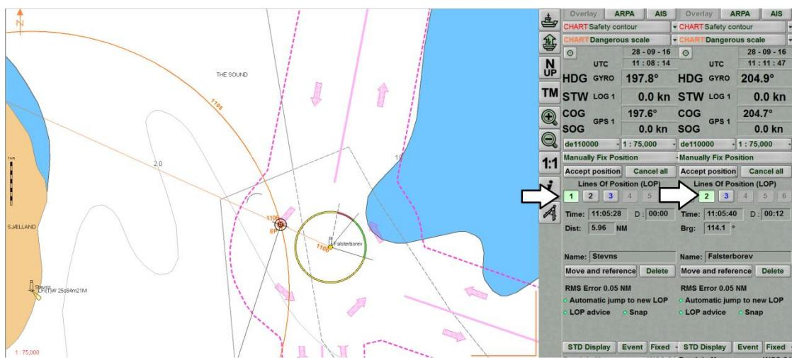
Slika 39. Pozicija provjerena funkcijom *Manually Fix Position* [13]
