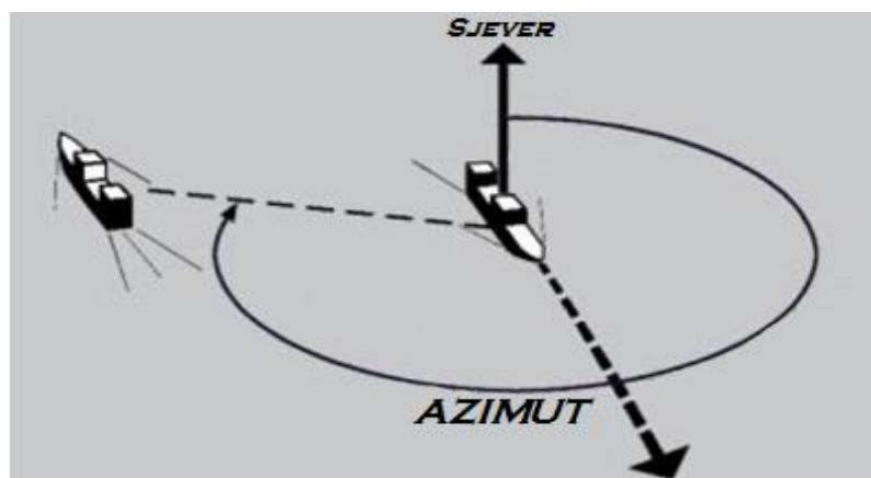
Slika 1. Azimut pravi [2]
