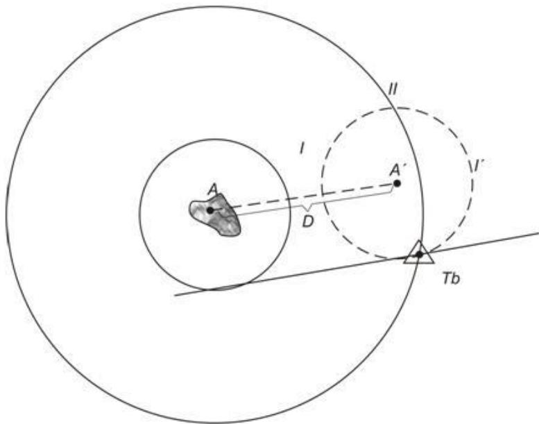
**Slika 24. Pozicija određena mjeranjem dviju udaljenosti od jednog objekta [6]**
