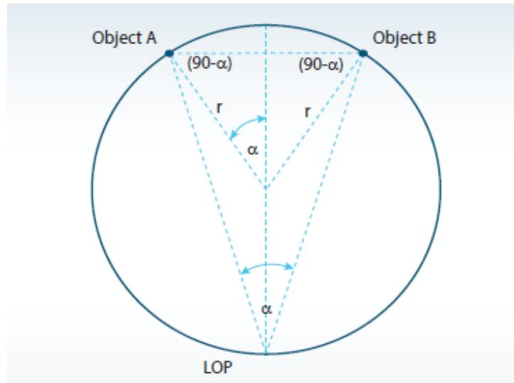
**Slika 5. Matematički izračun stajnice pomoću horizontalnog kuta [10]**
