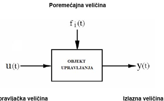
**Slika 9. Blok shema objekta upravljanja [17]**
