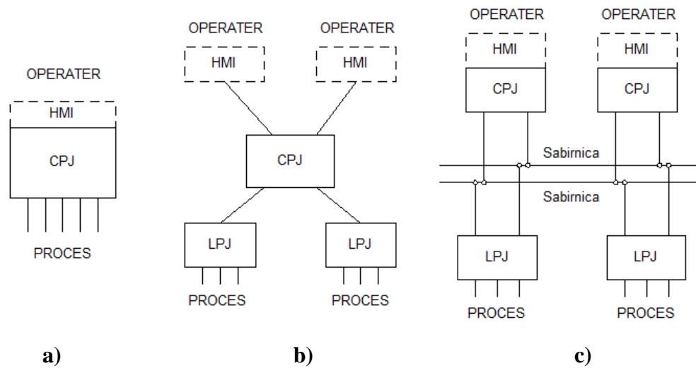
**Slika 16. Tri osnovne arhitektura elektroničkog sustava nadzora i upravljanja: a) centralizirana arhitektura; b) distribuirana arhitektura sa pojedinačnim vezama; c) mrežna distribuirana arhitektura [1]**
