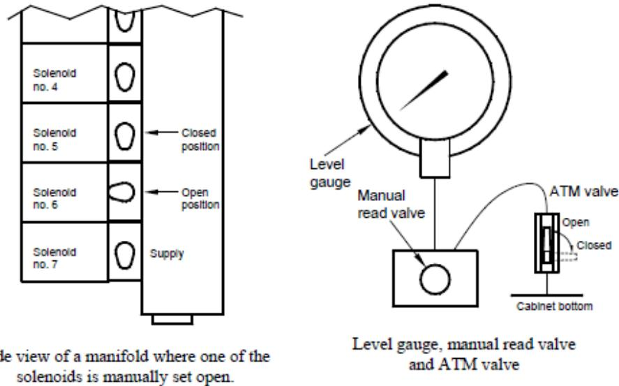
**Slika 33. Ručno mjerjenje razine tekućine u tankovima [26]**
