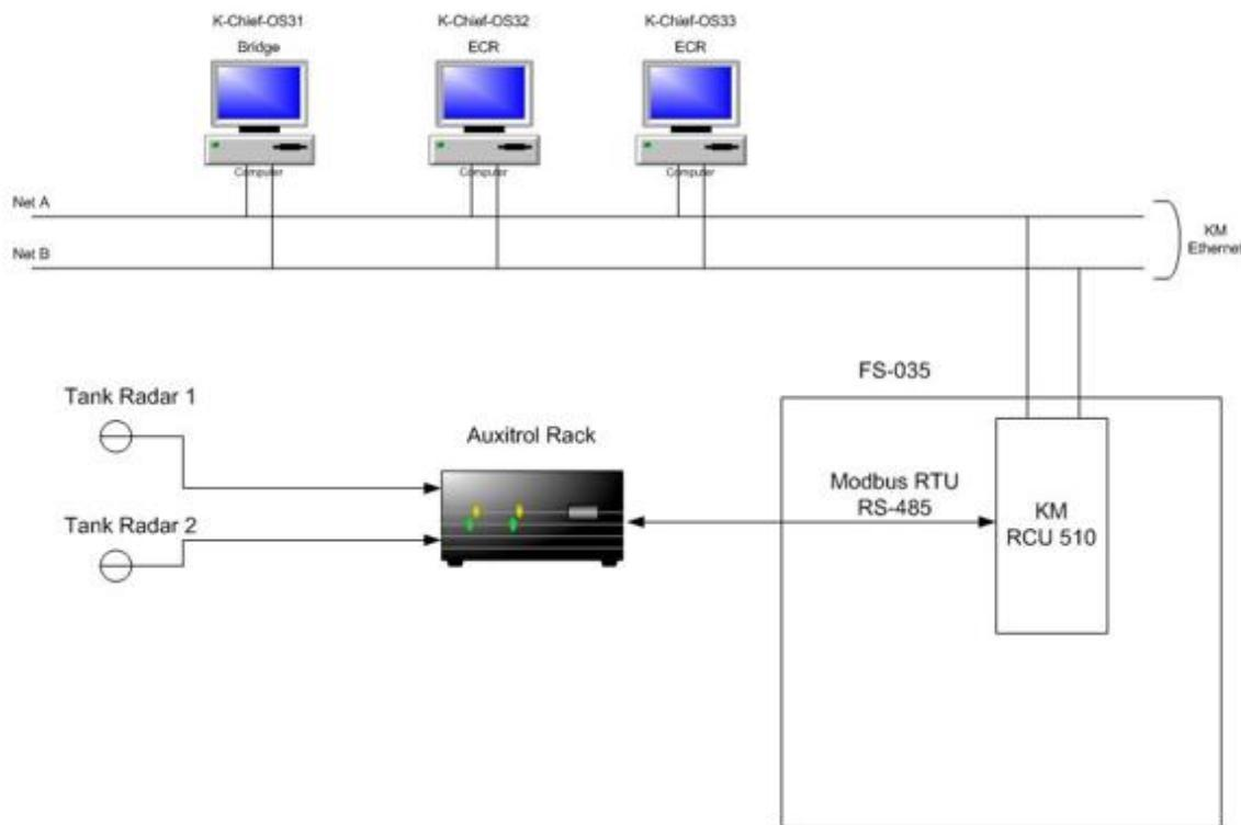
**Slika 38. Povezanost sustava daljinskog mjerjenja u tankovima sa HMI sučeljem na brodu [27]**
