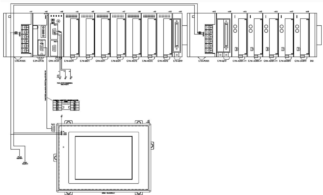
Slika 48. PLC za upravljanje hidrauličnim setom tereta [33]
