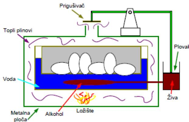
**Slika 4. Regulator topline u inkubatoru za piliće [8]**
