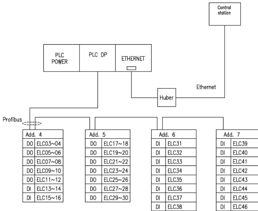
**Slika 45. Prikaz komunikacijske veze pneumatskih ventila sa PLC-om [29]**
