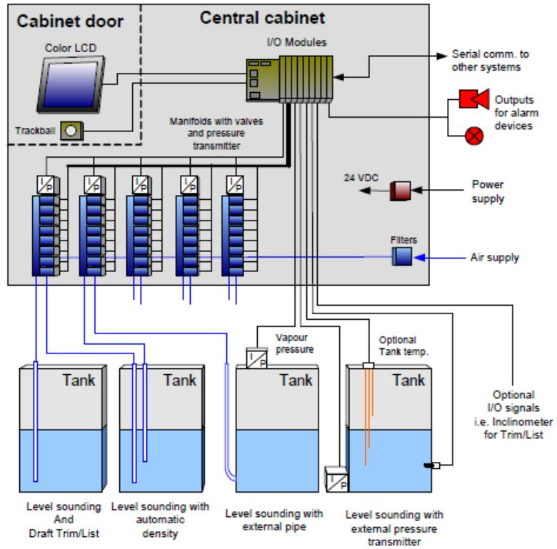
Slika 31. Blok dijagram daljinskog sondiranja tankova [26]
