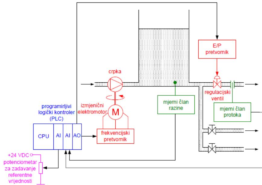
**Slika 24. Upravljanje razinom i protokom tekućine u tanku [19]**
