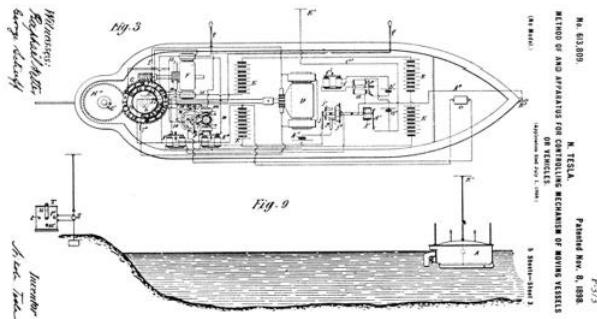
**Slika 7. Mehanizam za kontrolu broda i vozila u gibanju, metoda i uredaj, patent
