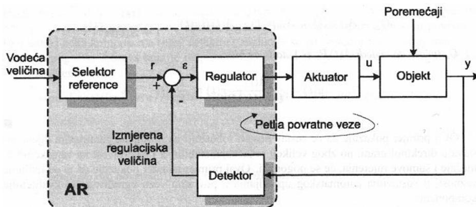
Slika 13. Blok shema sustava povratnog djelovanja [17]
