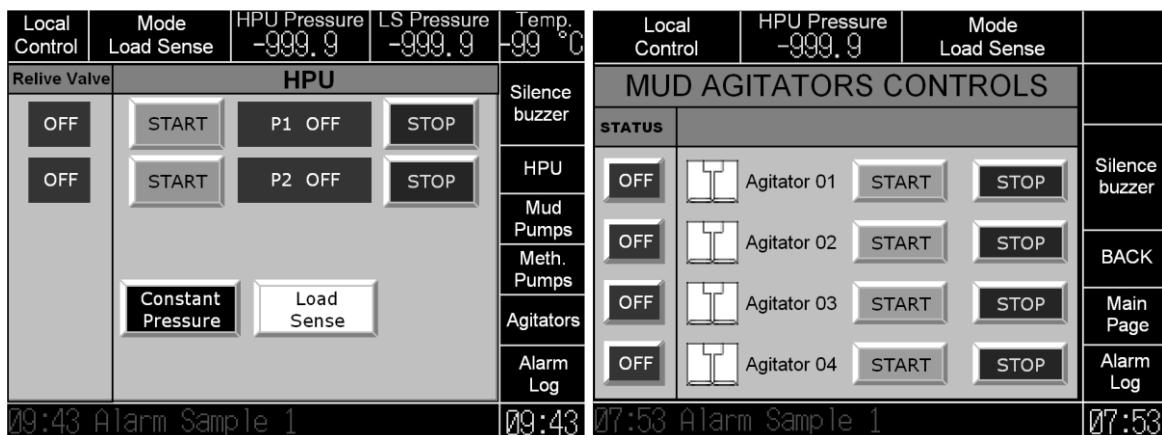
**Slika 49. Izgled LCD-sa glavnog kabineta upravljanja hidraulikom [34]**
