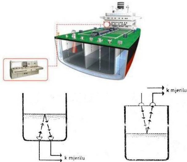
**Slika 21. Ultrazvučni mjerni pretvornik razine – principijelna shema [18]**
