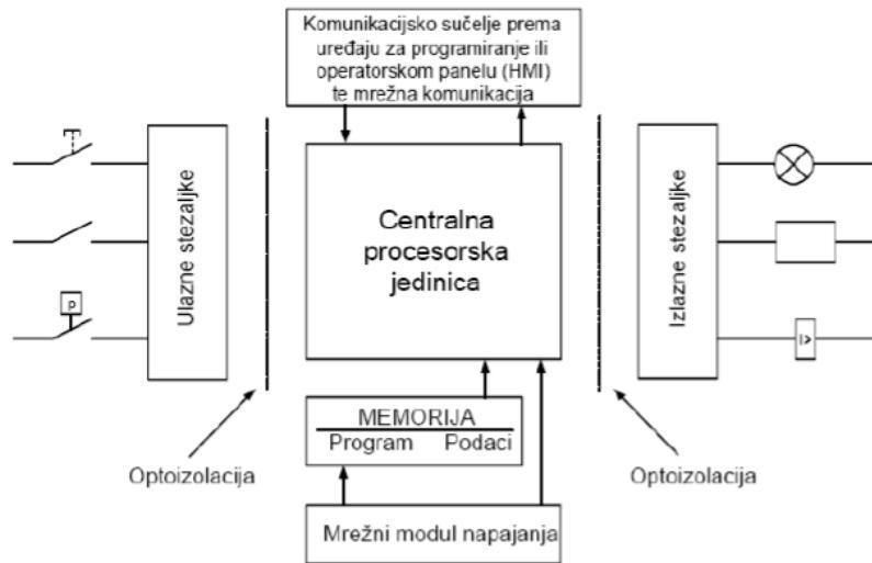
**Slika 27. Osnovni dijelovi PLC-a [18]**
